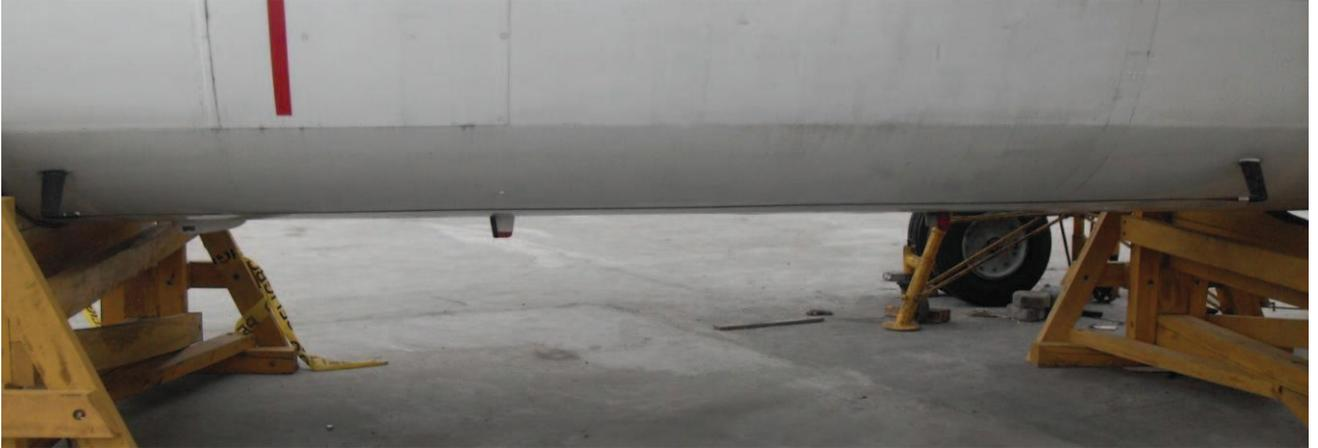
**Figura 3.22:** Antena sensor ADF lado derecho asegurada
