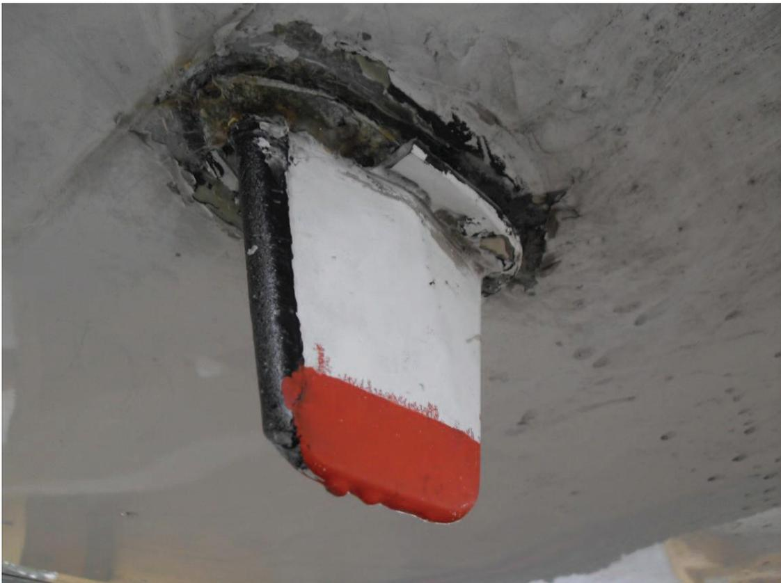
**Figura 3.20:** Antena DME instalado
