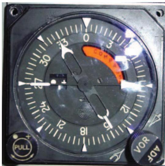
**Figura 2.18:** Indicador de dirección radio magnética
