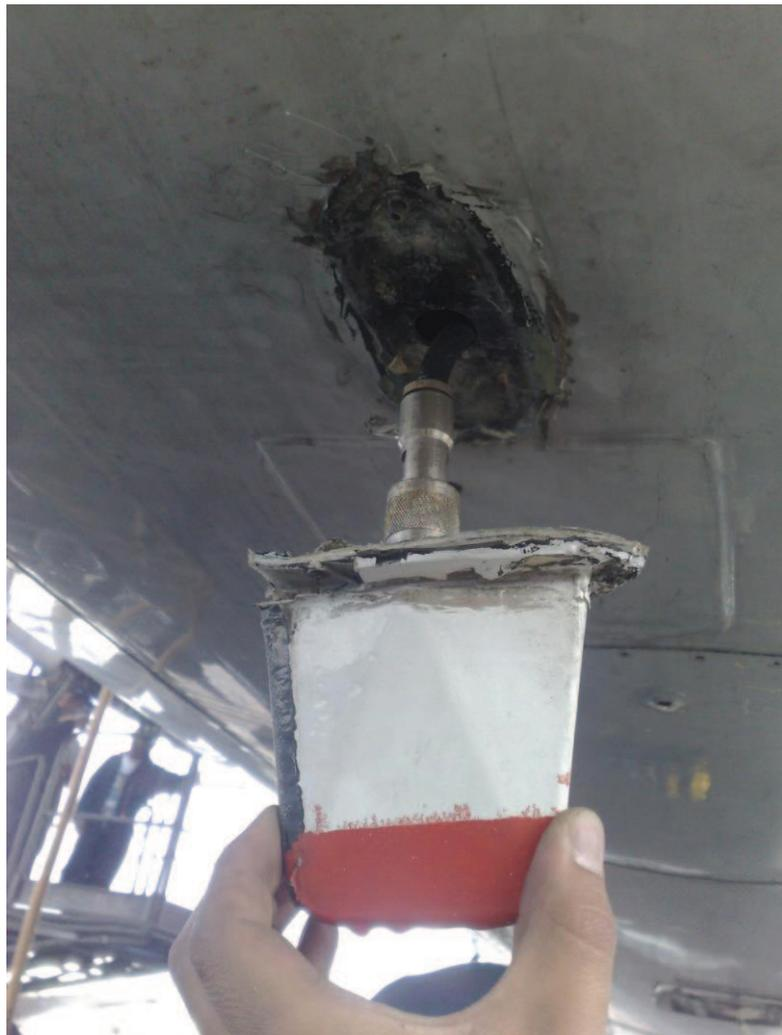
**Figura 3.6:** Conexión eléctrica de la antena DME
