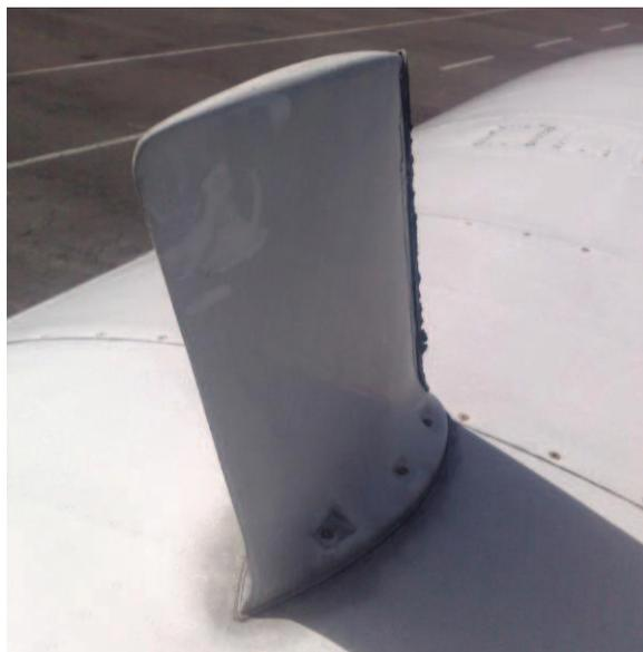
**Figura 3.17:** Antena VHF instalado en la parte superior del fuselaje
