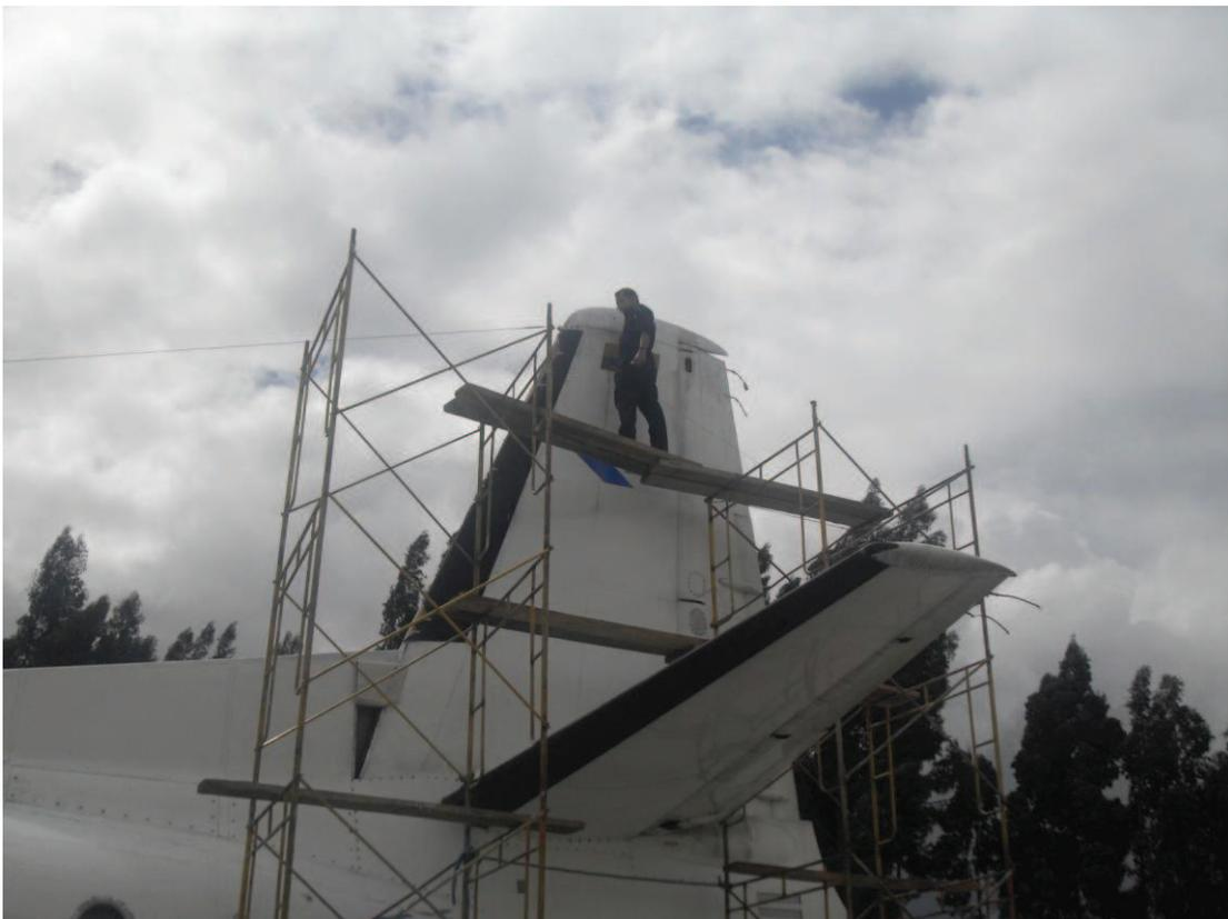
**Figura 3.19:** Instalación de la antena HF COMM
