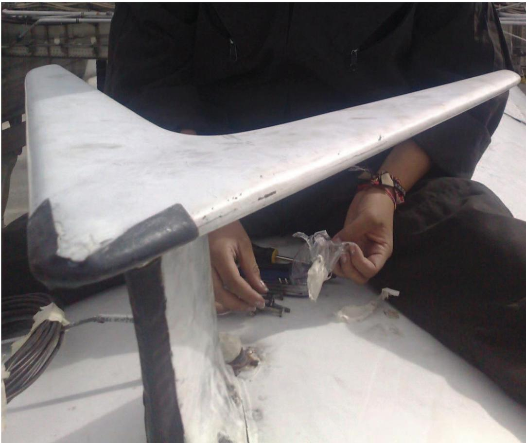
**Figura 3.18:** Antena VHF COM/NAV instalada
