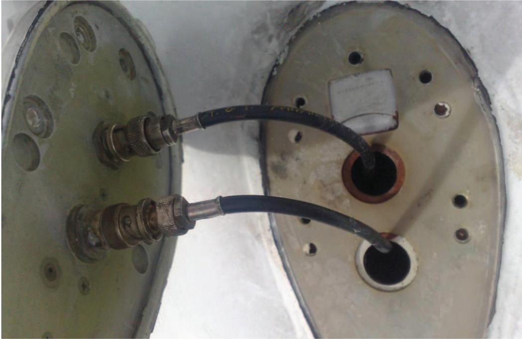
**Figura 3.3:** Agujeros de los pernos que aseguran la antena VHF COM/NAV
