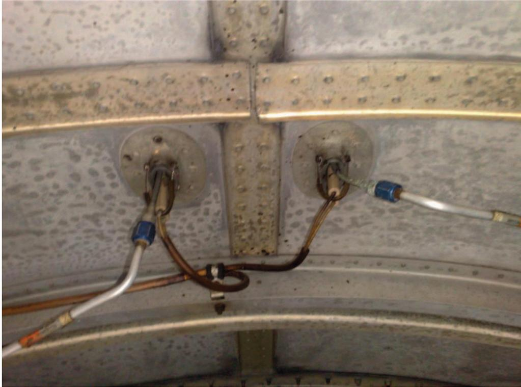
**Figura 3.14:** Conexiones neumática y eléctrica de los tubos pitot
