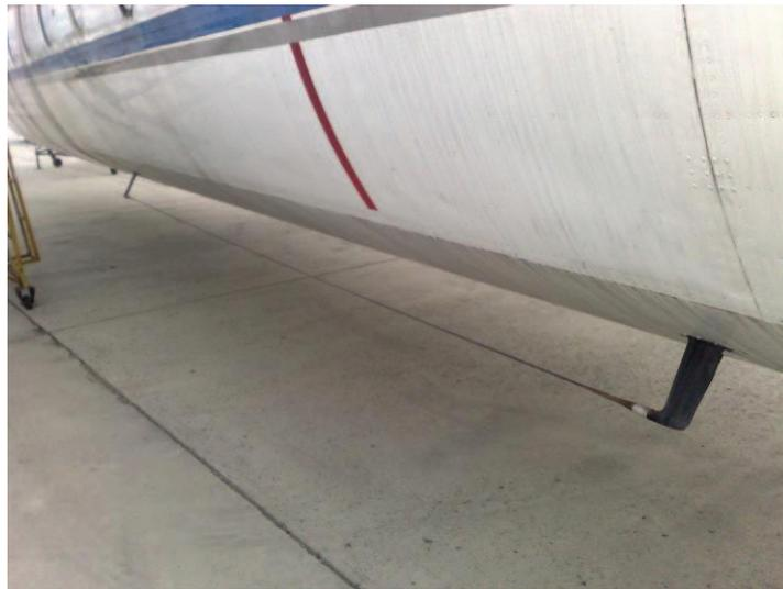
**Figura 3.10:** Antena sensor ADF lado derecho
