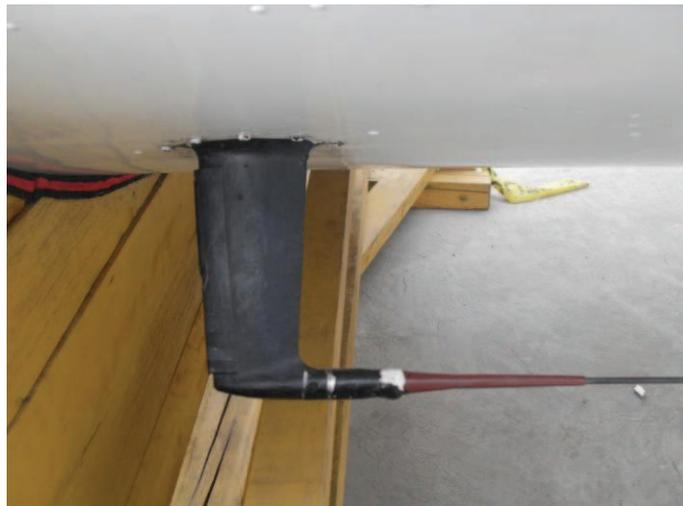
**Figura 3.11:** Componente de la antena sensor ADF asegurada al fuselaje
