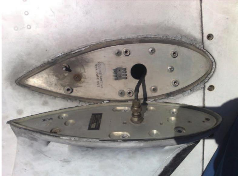
**Figura 3.2:** Conexión eléctrica de la antena VHF COMM
