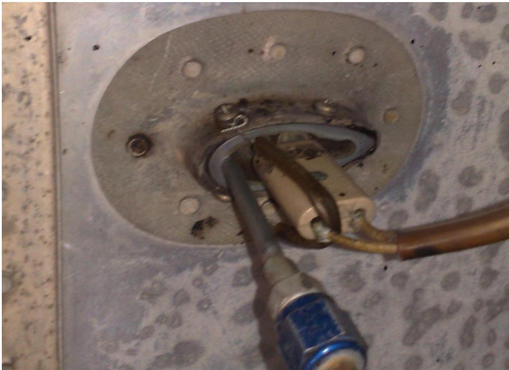
**Figura 3.13:** Tornillos que aseguran a los tubos pitot
