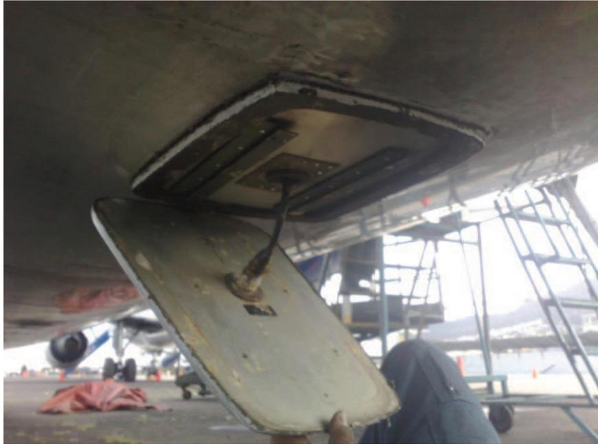
**Figura 3.8:** Conexión eléctrica de la antena loop ADF
