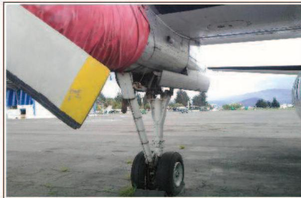
**Figura 2.3.- Compartimento del tren de aterrizaje del FH-227**
