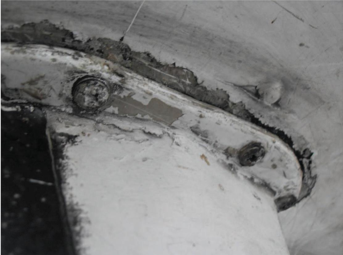
**Figura 3.7:** Tornillos que aseguran la antena DME al fuselaje
