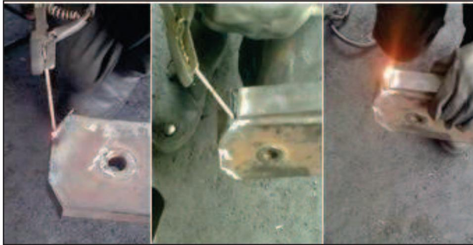
**Figura 3.9.** Unión de la viga con la platina
