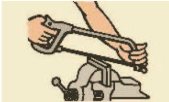
**Figura 2.21.** Pieza fijada firmemente antes de serrar
