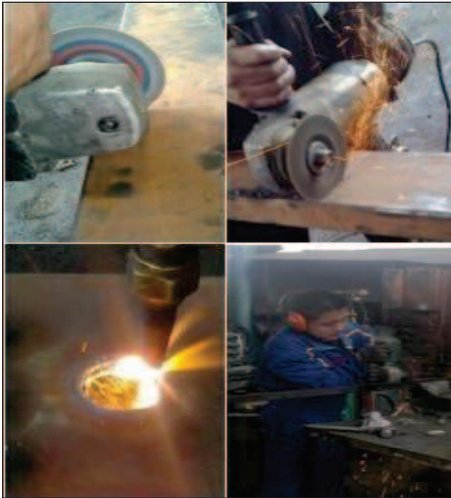
**Figura 3.8.** Cortes del perfil rectangular y platina
