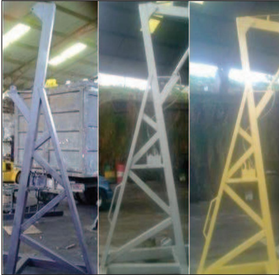
**Figura 3.7.** Pintura del soporte vertical
