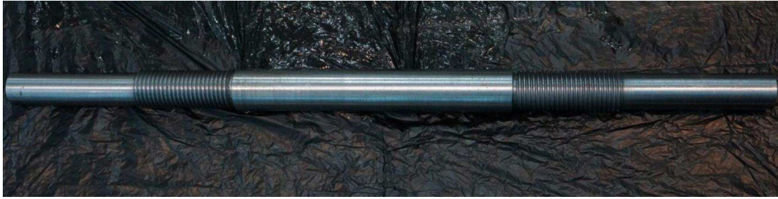
Figura 3.19: Fin de la elaboración del eje (desbaste-roscado)
