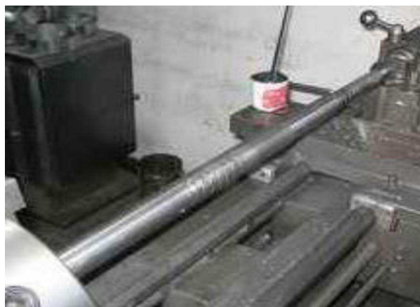
Figura 3.12: Montaje del eje Fuente: Sr. Valencia Johnatan
