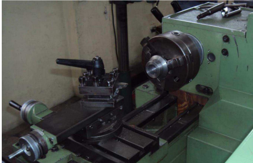
Figura 3.37: Torneado de las bases, acero de 2 1/2"
