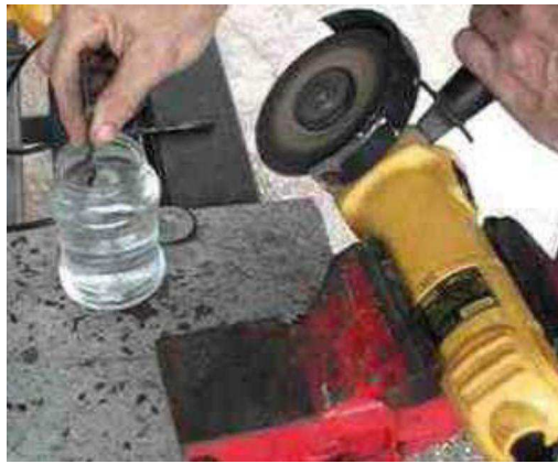
Figura 3.17: Afilado de cuchillas para el roscado
