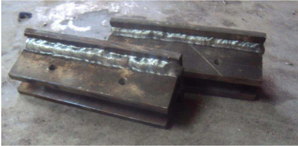
Figura 3.23: Platinas soldadas entre sí para los puntos de apoyo Fuente: Sr. Valencia Johnatan
