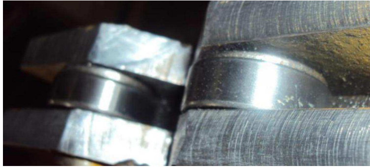
Figura 3.25: rodamientos en sus puntos de apoyo Fuente: Sr. Valencia Johnatan
