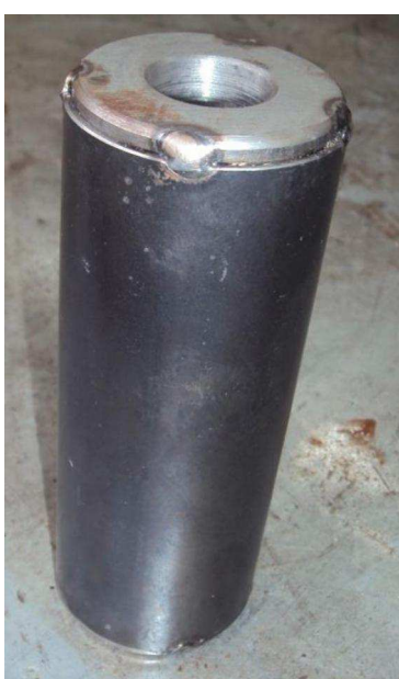
Figura 3.41: Acople para tornillo de fijación Fuente: Sr. Valencia Johnatan
