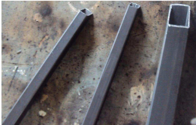
Figura 3.27: Cortes de los tubos cuadrados Fuente: Sr. Valencia Johnatan
