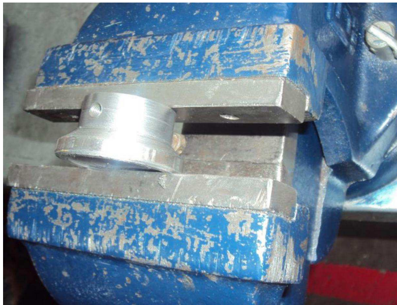
Figura 3.38: Orificios para acopar base-tornillo Fuente: Sr. Valencia Johnatan
