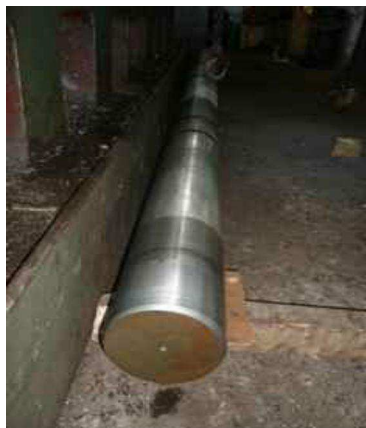
Figura 3.16: Elaboración de la pieza (desbaste-roscado)
