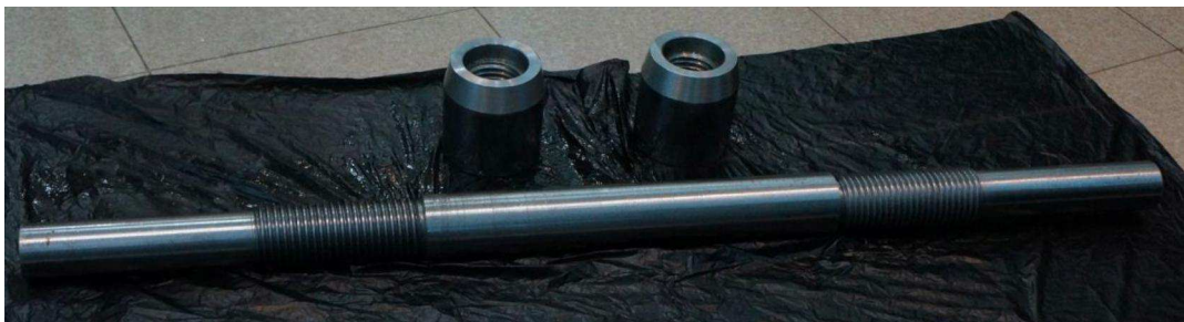
Figura 3.22: Eje con sus tuercas de seguridad
