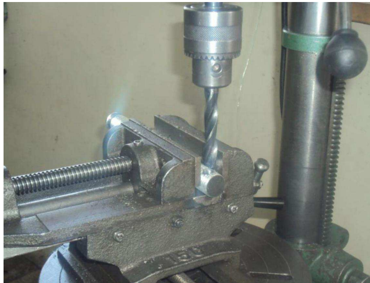
Figura 3.33: Perforación en la parte superior del eje
