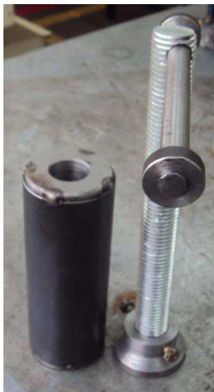
Figura 3.42: Componentes del tornillo de fijación Fuente: Sr. Valencia Johnatan
