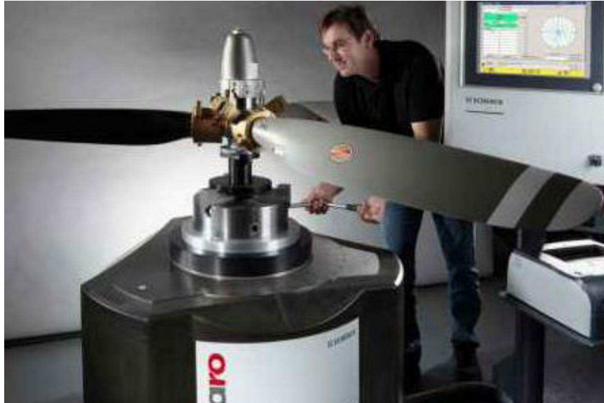
Figura 2.28: Equipo para calibrar flojedad de palas y cubo. Fuente: http://www.schenck-rotec.com.mx/products/products/Taro.php .
