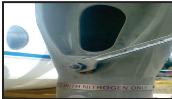
Figura: 3.39. Aflojamiento de la tapa de la válvula de llenado
