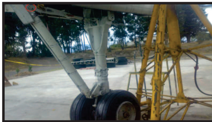
Figura: 3.21. Montante de bloqueo sujeto al montante de resistencia
