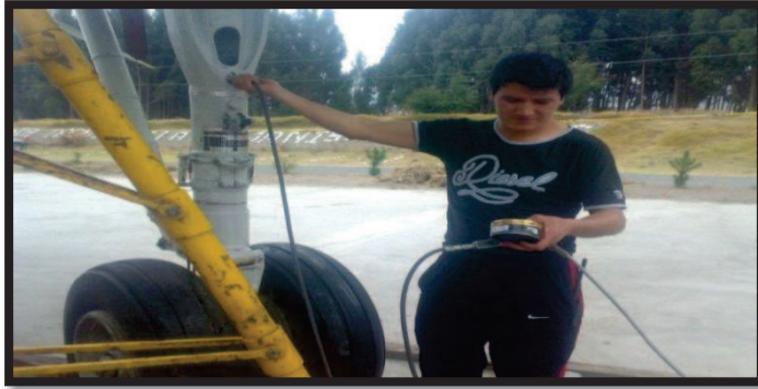
Figura: 3.42. Cargado con nitrógeno comprimido en la cámara del tren
