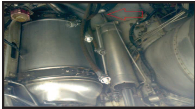
Figura: 3.22. Parte superior del actuador sujeto al herraje del avión
