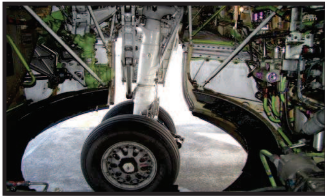
Figura: 2.9. Vista desde el interior del compartimiento del tren de aterrizaje principal de un Boeing 737
