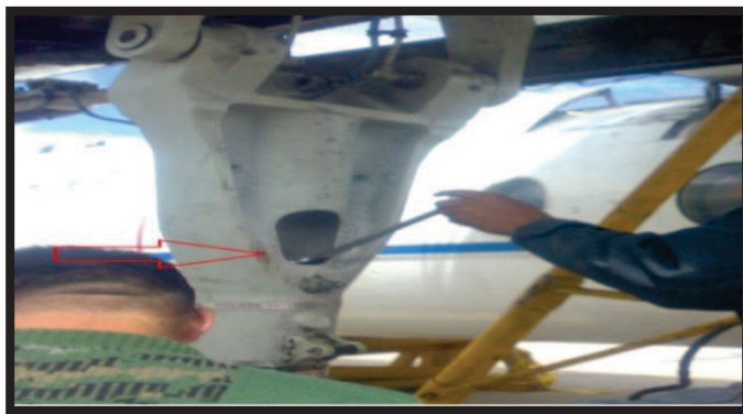
Figura: 3.34. Aflojamiento de la tuerca de seguridad del montante amortiguador
