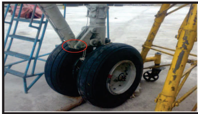
Figura: 3.15. Montante de arrastre colocado en la parte inferior
