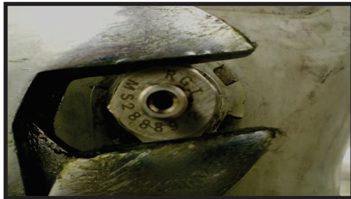
Figura: 3.44. Torque de la tuerca de llenado de nitrógeno
