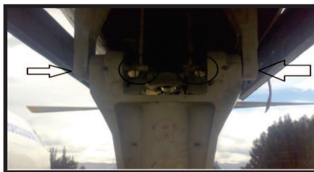
Figura: 3.13. Pernos sujetos con tuercas y seguros del montante amortiguador
