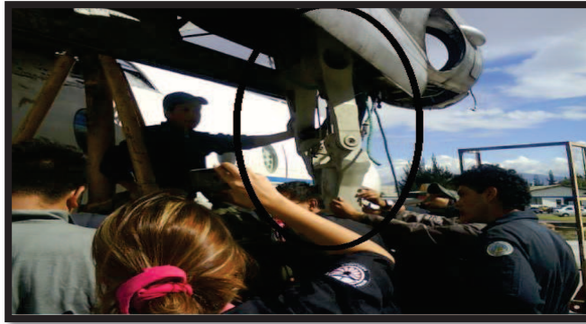
Figura: 3.11. Montante amortiguador en la posición correcta
