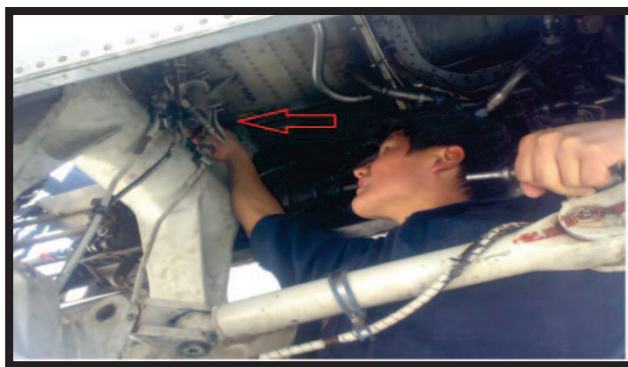
Figura: 3.26. Líneas neumáticas aseguradas a las uniones del tren
