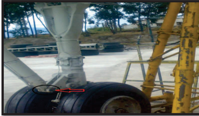
Figura: 3.18. Montante de arrastre sujeto al tren
