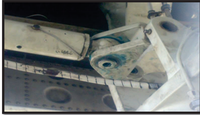
Figura: 3.20. Montante de bloqueo sujetado al montante amortiguador
