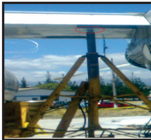
Figura: 3.3. Gato hidráulico ubicado en un punto del ala del avión
