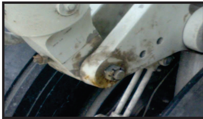
Figura: 3.30. Engrasado los puntos de sujeción
