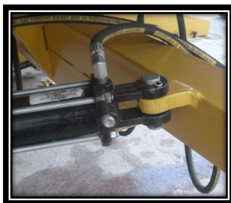
Figura 3.35. Pasador empleado en Cilindro Hidráulico.
