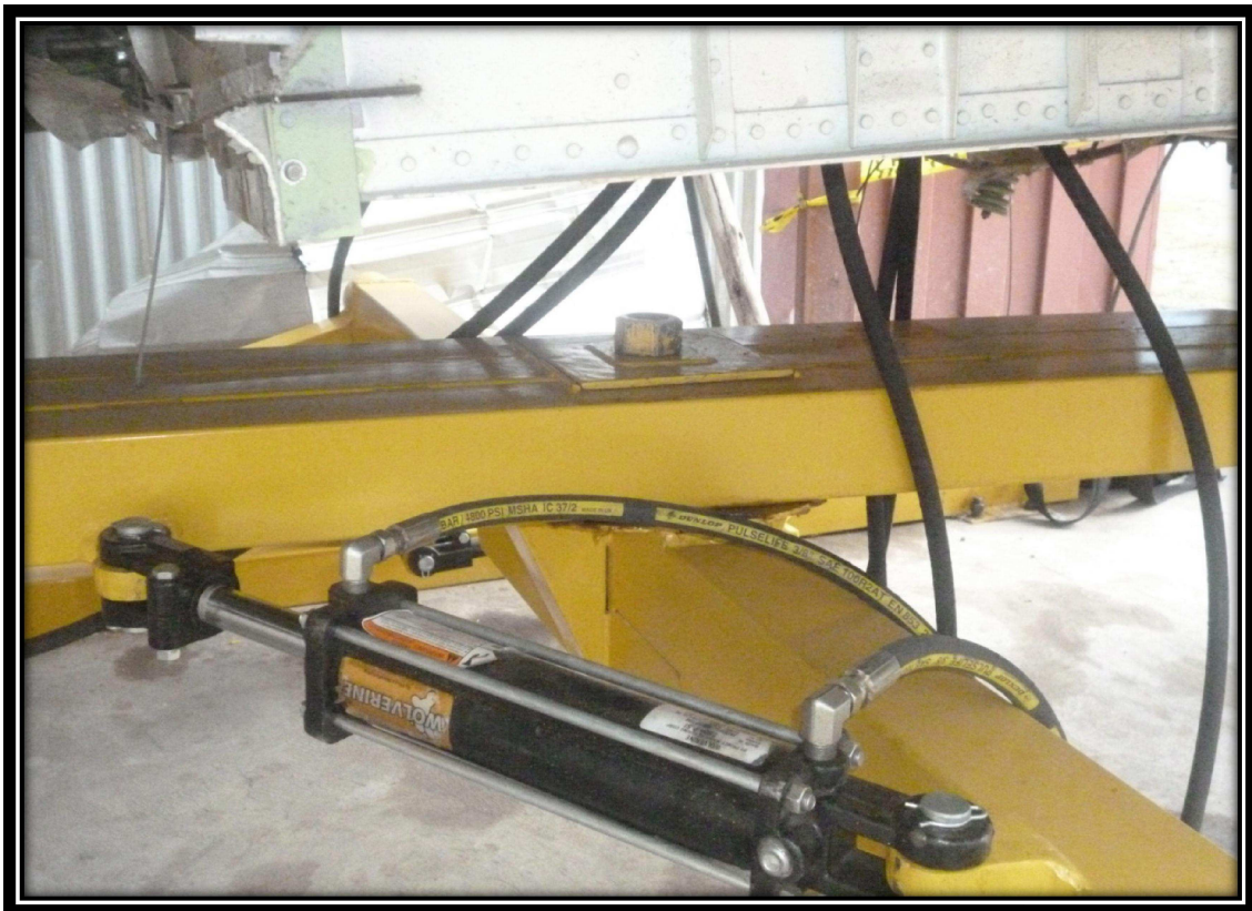
Figura 3.29. Estructura simuladora del movimiento de guiñada
