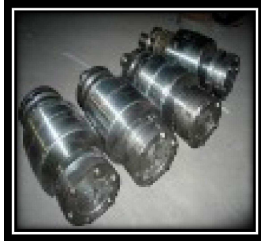
Figura 3.32. Eje Cilíndrico de Acero A36
