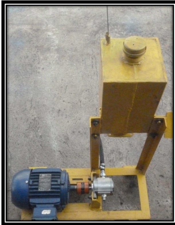
Figura 3.27. Depósito de aceite hidráulico
