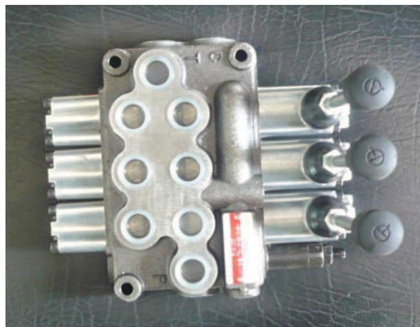
Figura 3.4 Conjunto de válvulas distribuidoras 4/3 mando por palancas
