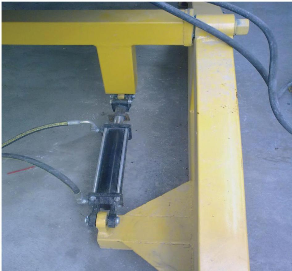
Figura 3.26 Colocación del cilindro en la estructura
