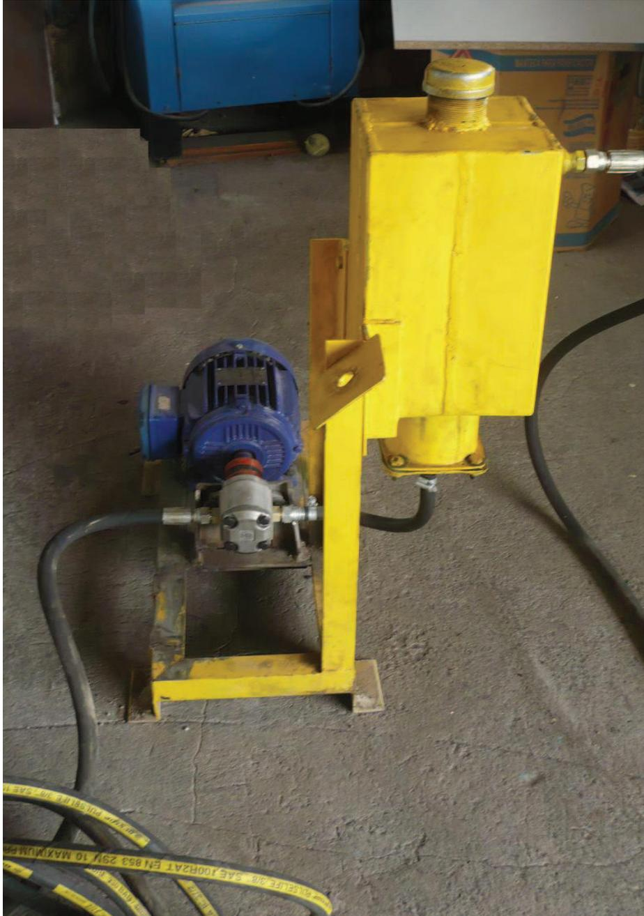
Figura 3.27 Sistema hidráulico de la estructura.
