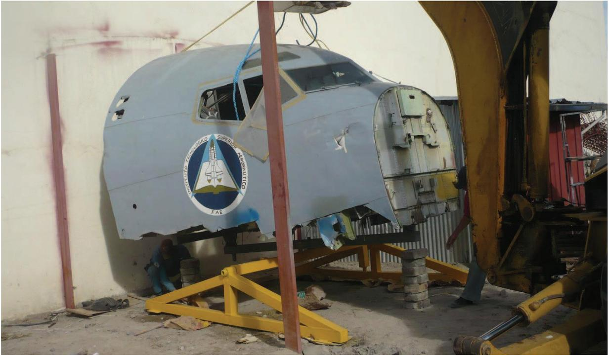
Figura 3.25 Montaje de la cabina sobre la estructura.
