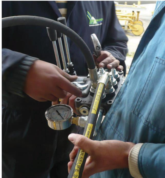
Figura 3.21 Instalación de las cañerías al cuerpo de válvulas.
