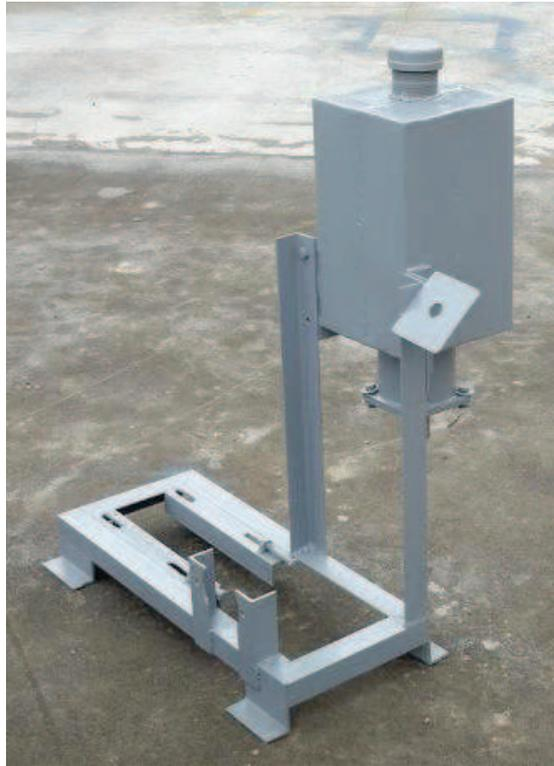
Figura 3.5. Deposito del líquido hidráulico
