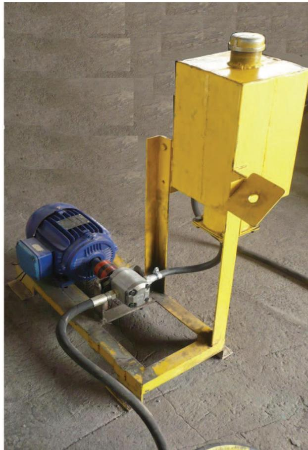
Figura 3.24 Unión de la bomba y el motor eléctrico mediante matrimonio.
