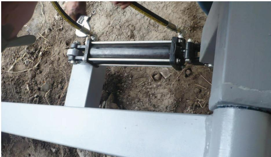
Figura 3.22 Unión de las cañerías y el cilindro hidráulico.
