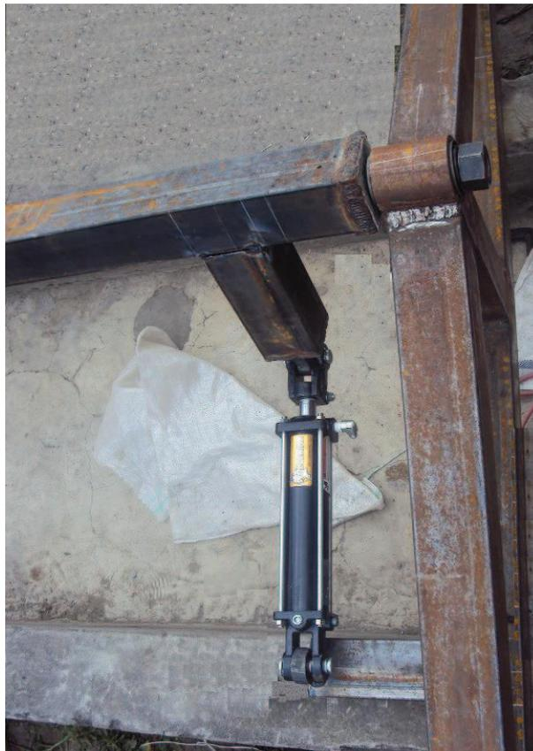
Figura 3.18 Palanca soldada al eje principal.
