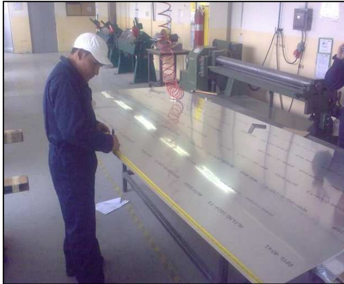
Figura 2.56: Lámina de Alclad aluminio 2024-T3; 0.40.
