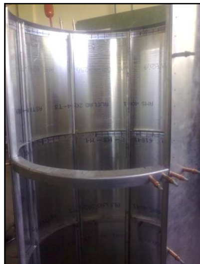
Figura 2.68: Unión de las piezas por medio de clecos.
