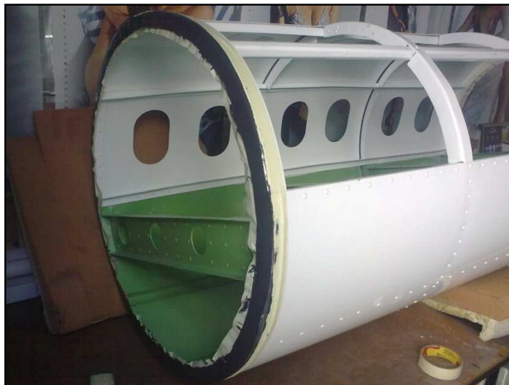
Figura 2.75: Fuselaje aplicado PRC en sus extremos y entre pieza y pieza. Fuente: Investigación de campo
