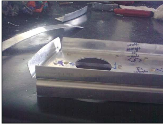
Figura 2.70: Floor beam con su respectivo ángulo.
