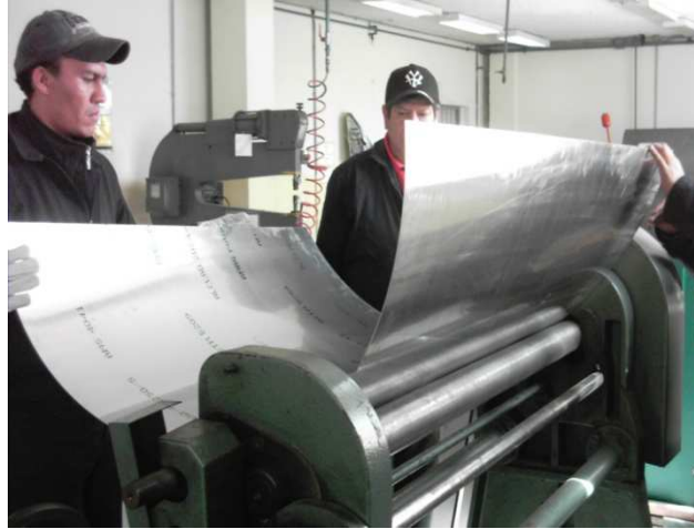
Figura 2.62: Formación del revestimiento en la baroladora.
