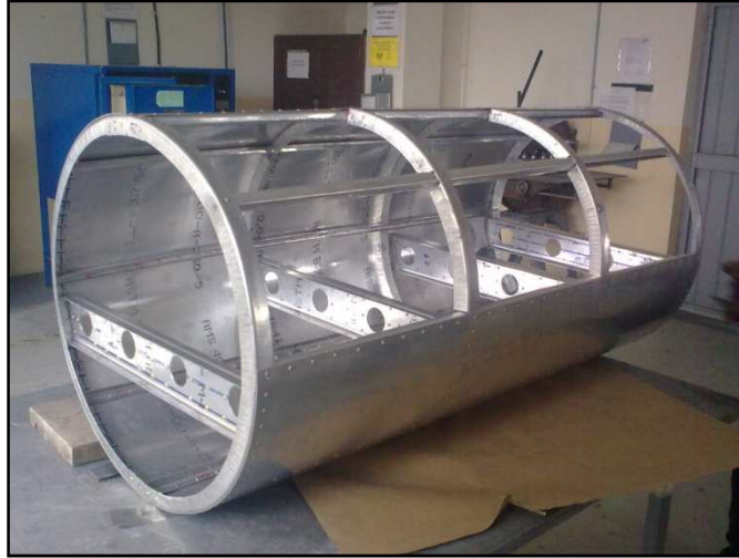
Figura 2.73: Estructura remachada con todas sus piezas.
