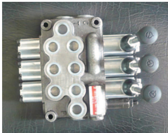
Figura 3.5 Conjunto de válvulas distribuidoras 4/3 mando por palancas
