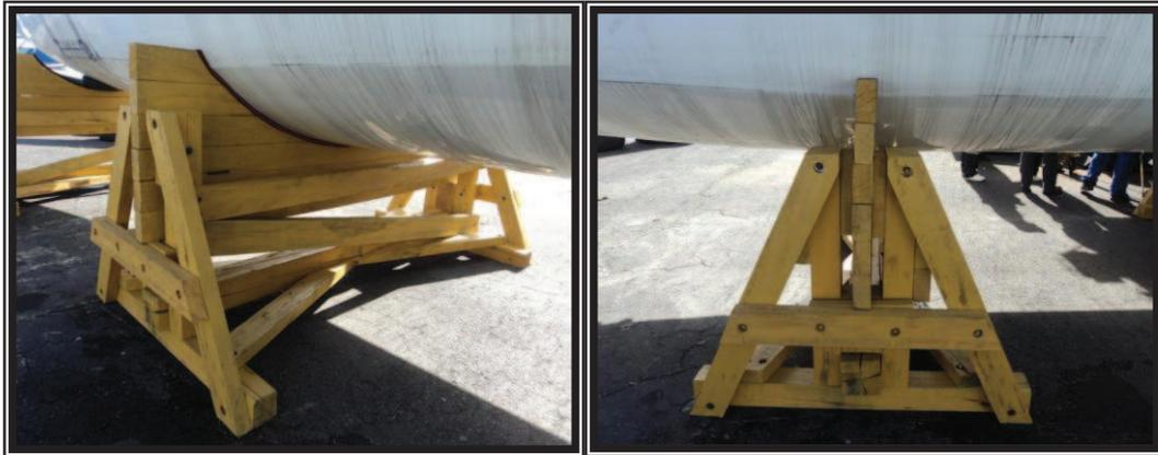
**Figura 3.31.** Soporte en la estación 475.394 del fuselaje.
