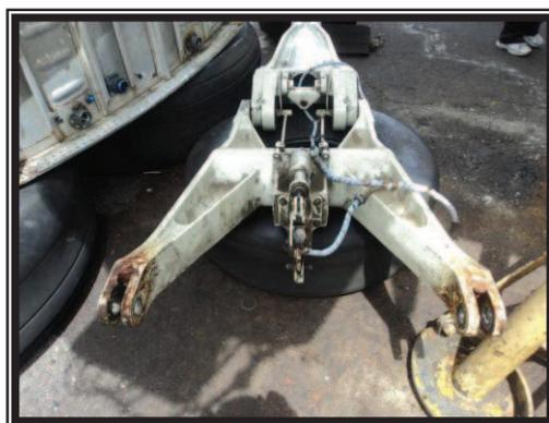
**Figura 3.38.** Tren principal izquierdo desmontado.
