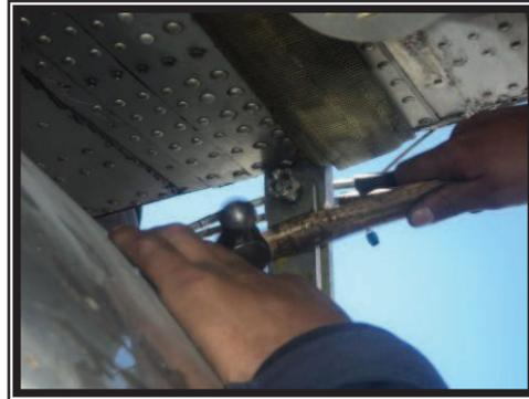
**Figura 3.54.** Remoción de los 8 pernos internos y externos del fuselaje
