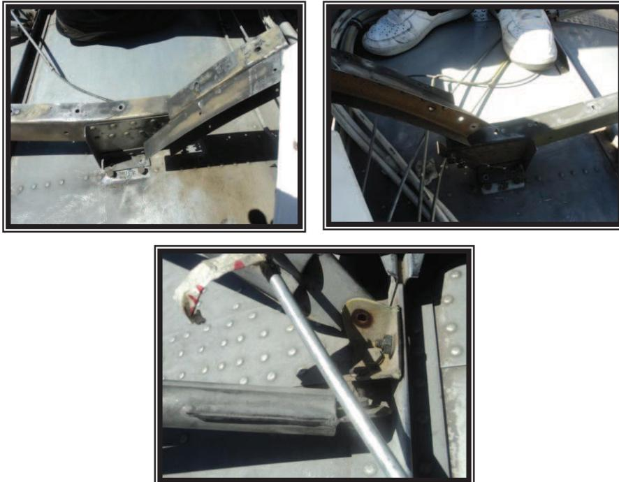
**Figura 3.41.** Puntos de sujeción de la parte superior del ala central con el fuselaje.
