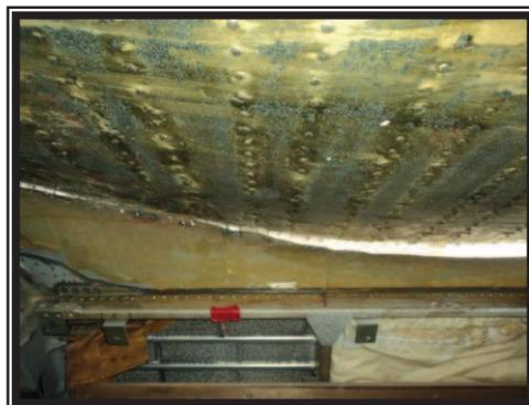
**Figura 3.47.** Separación de las dos placas (ala central y fuselaje).
