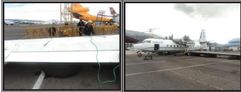
**Figura 3.29.** Desconexión de las eslingas, y estabilidad del ala desmontada.
