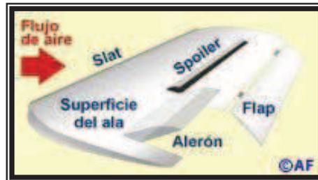
**Figura 2.33.** Superficies flexibles principales situadas en las alas de los aviones.
