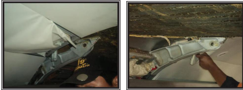
**Figura 3.51.** 2 Puntos de sujeción interior, del ala central contra el fuselaje (Ala derecha).
