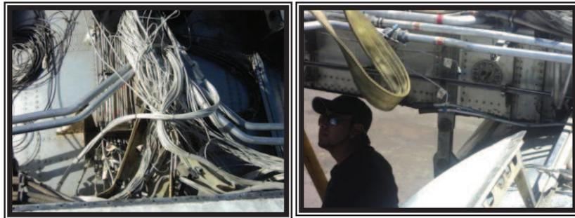
**Figura 3.40.** Desconexión de alambres de controles de vuelo, y tendido eléctrico.
