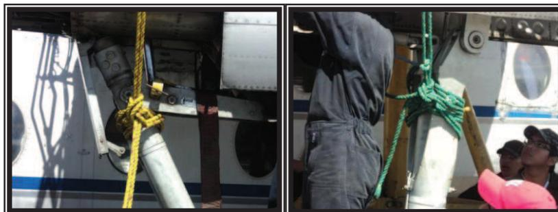
**Figura 3.36.** Sujeción del tren al tecele.
