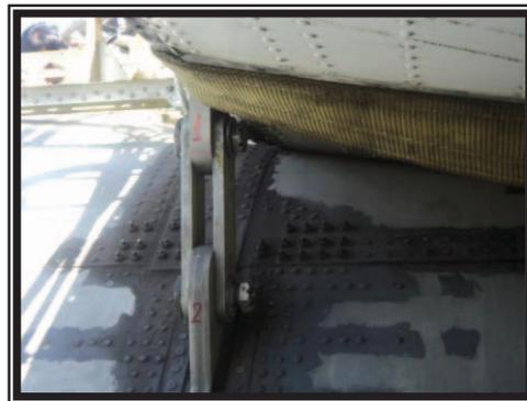
**Figura 3.49.** 2 Puntos de sujeción exterior, del ala central contra el fuselaje (Ala derecha).
