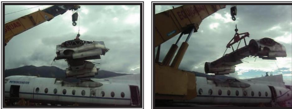
**Figura 3.58.** Desprendimiento del ala central y el fuselaje.
