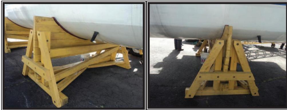
**Figura 3.32.** Soporte en la estación 333.661 del fuselaje.
