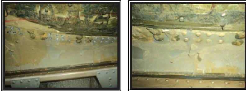
**Figura 3.42.** Remaches parte interior del fuselaje que une al ala central.
