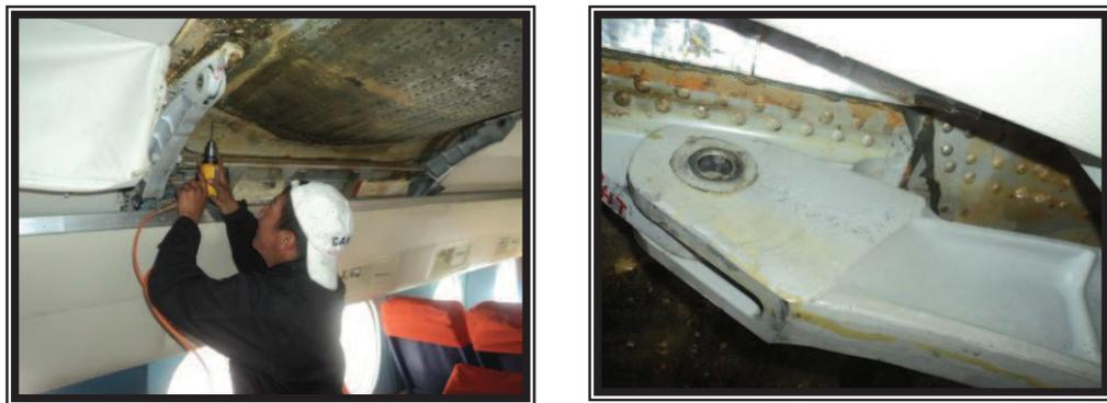
**Figura 3.52.** 2 Puntos de sujeción interior, del ala central contra el fuselaje (Ala izquierda).
