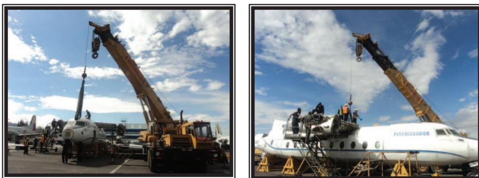
**Figura 3.53.** Colocación de fajas alrededor del ala central (montacargas grande)
