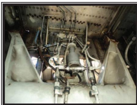
**Figura 3.37.** Puntos de sujeción del tren principal.
