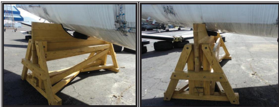
**Figura 3.30.** Soporte en la estación 637.598 del fuselaje.
