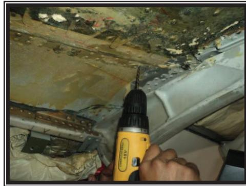
**Figura 3.46.** Perforamiento de remaches.
