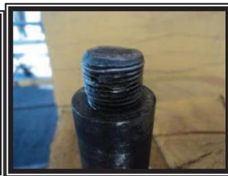
**Figura 3.56.** Pernos de sujeción del ala central contra el fuselaje.
