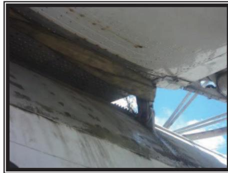
**Figura 3.50.** 2 Puntos de sujeción exterior, del ala central contra el fuselaje (Ala izquierda).
