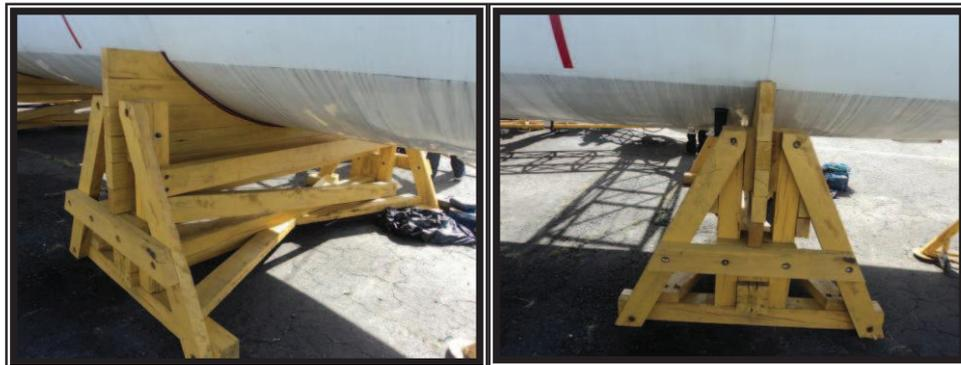
**Figura 3.33.** Soporte en la estación 198.819 del fuselaje.
