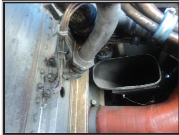
**Figura 3.10.** Líneas de combustible y tubos de ventilación (Botas).
