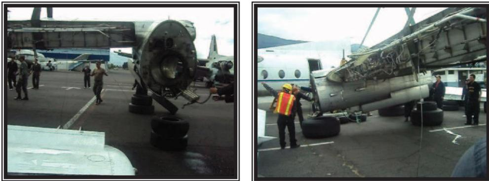
**Figura 3.60.** Asentamiento del ala central sobre neumáticos.
