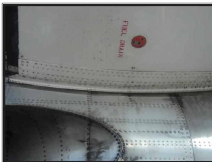
**Figura 3.7.** Punto de drenaje del combustible.
