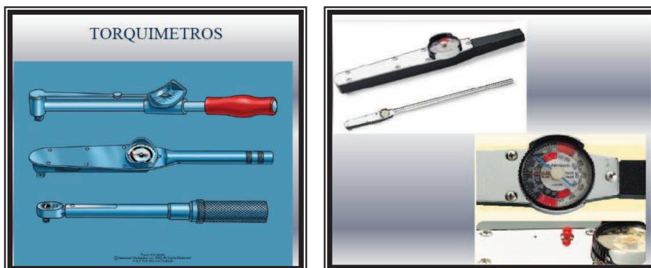
**Figura 2.79.** Torquímetros.
