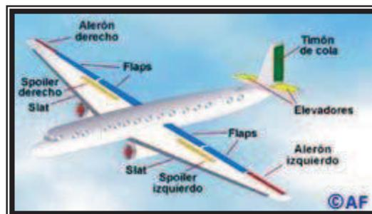
**Figura 2.32.** Superficies flexibles de control.
