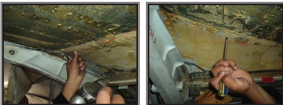
**Figura 3.43.** Señalamiento de todos los remaches.
