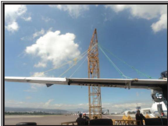
**Figura 3.16.** Eslingas y sogas tensionadas.
