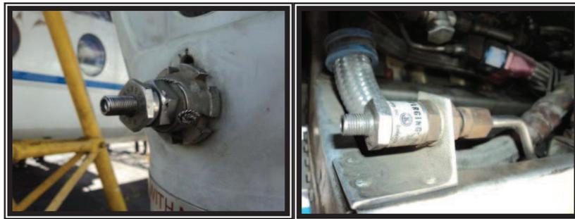
**Figura 3.35.** Puntos para aliviar la presión; actuador y sistema del tren principal.
