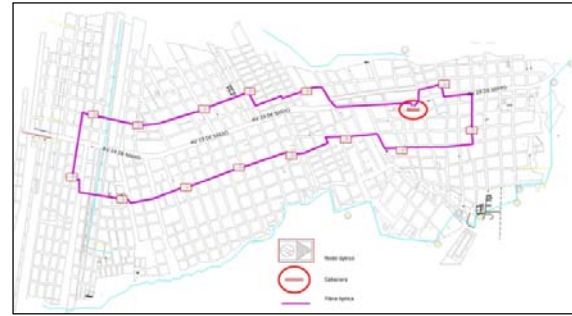
Figura 4 Diagrama de anillo de Fibra Óptica y nodos sobre planos de la ciudad de La Maná.
