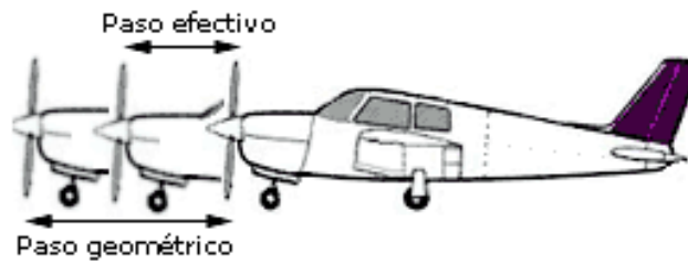
Figura 1.13. Paso efectivo y paso geométrico
