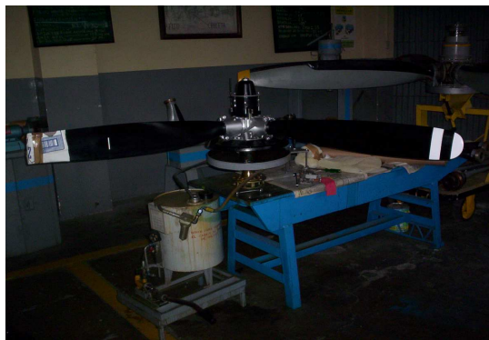
Figura 1.18. Hélice en posición de bandera
