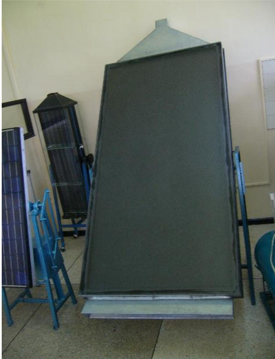
**Fotografía 5.1. Colector armado**
