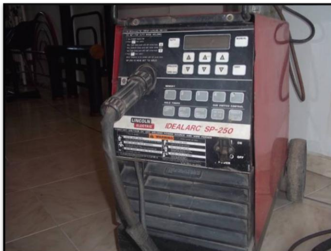
Figura 2.24 Soldadora Lincoln, modelo idealarc sp250, amperaje de salida 300a, 220v.
