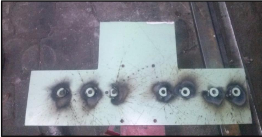
Figura 4.23 Soldadura de bujes a la placa intercambiable.
