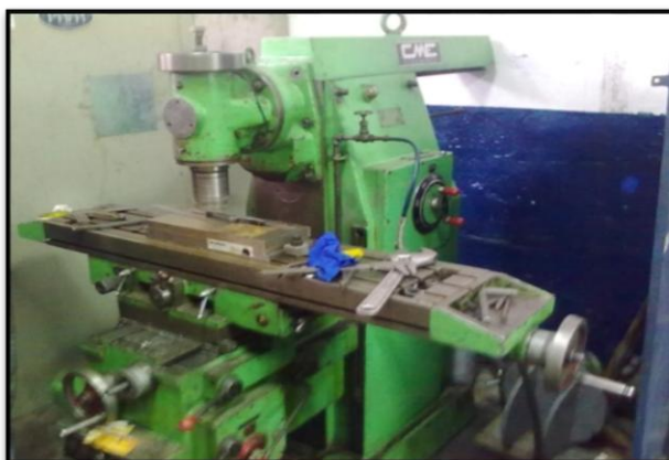
Figura 2.17 Fresadora CME, modelo fu205, potencia 8hp, 220v.
