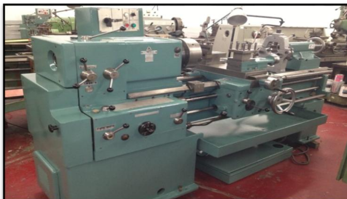
Figura 2.16 Torno Italco, modelo tos-sn50b, motor principal 5.5kw / 7.5hp, alimentación eléctrica 220 v / 60hz.
