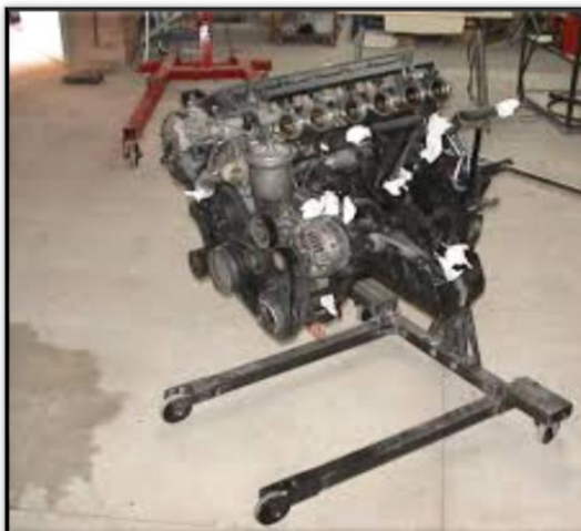
Figura 2.6 Soporte de motor en forma longitudinal.
