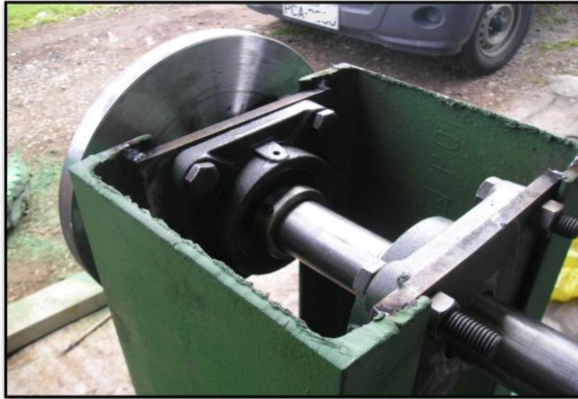
Figura 4.20 Instalación del disco eje.
