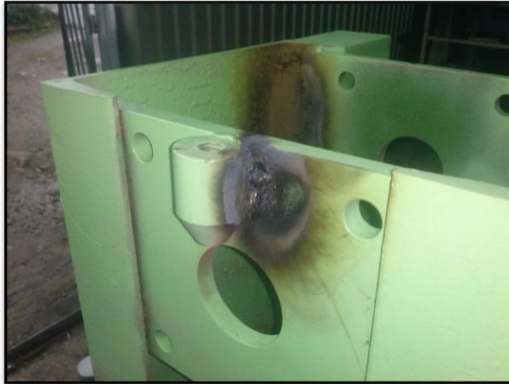
Figura 4.16 Soldadura del alojamiento del pin de bloqueo.
