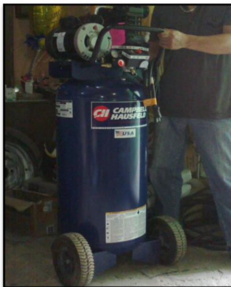
Figura 2.25 Compresor Campbell hausfeld, modelo tde34-23, presión máxima 80 MPa, potencia 2kw, 220v.
