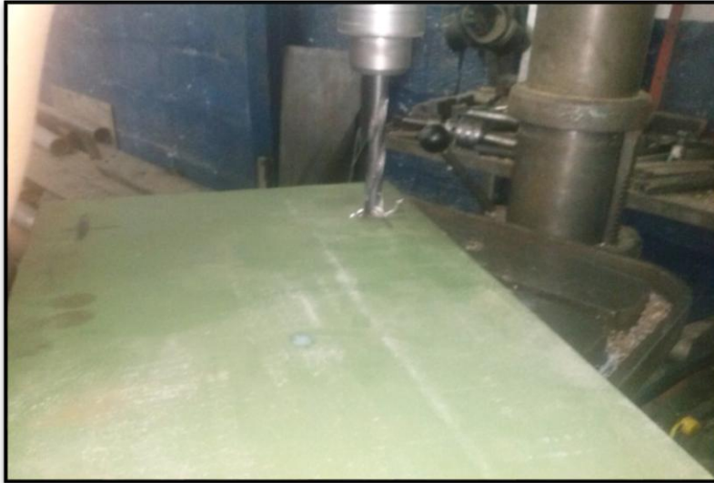
Figura 4.8 Taladrado de las vigas.
