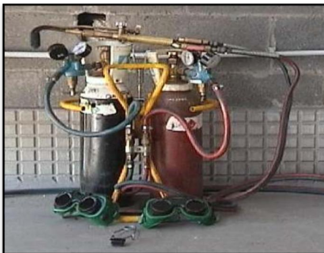
Figura 2.20 Oxicorte Excoweld, modelo eqp 48-2-si2, capacidad de corte 25.4mm, capacidad de soldadura hasta 13mm.
