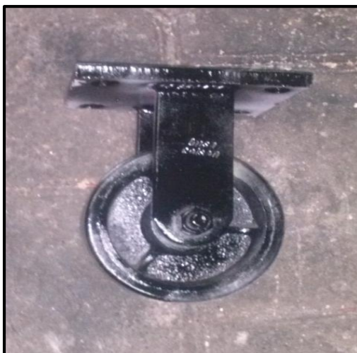
Figura 2.29 Garrucha PR-5. Capacidad de carga hasta 500 kg, diámetro de la rueda 10.25 mm, composición núcleo de acero fundido recubierto de poliuretano.
