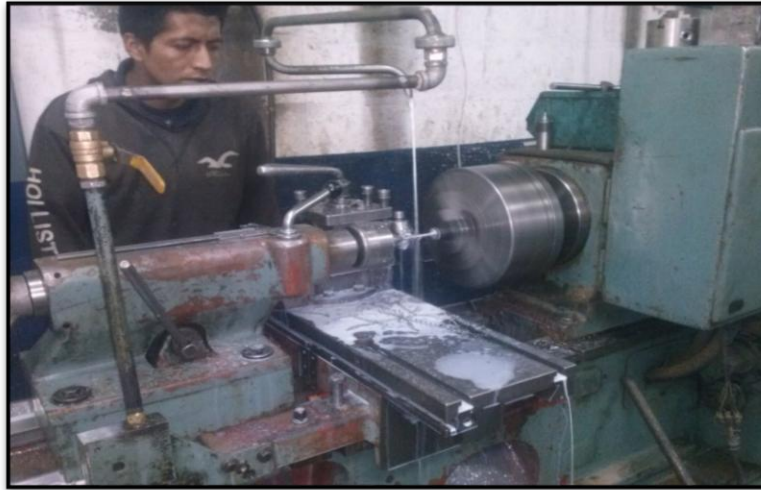
Figura 4.17 Proceso de torneado y cilindrado del conjunto disco-eje.
