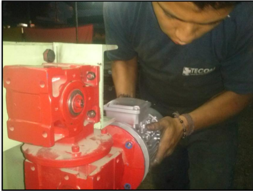
Figura 4.27 Ensamble del motor eléctrico.
