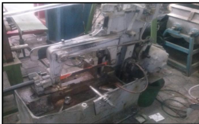
Figura 2.19 Sierra de ciclo Marvel chicago, modelo mfg tm54, 1.5w, trifásico 220v.
