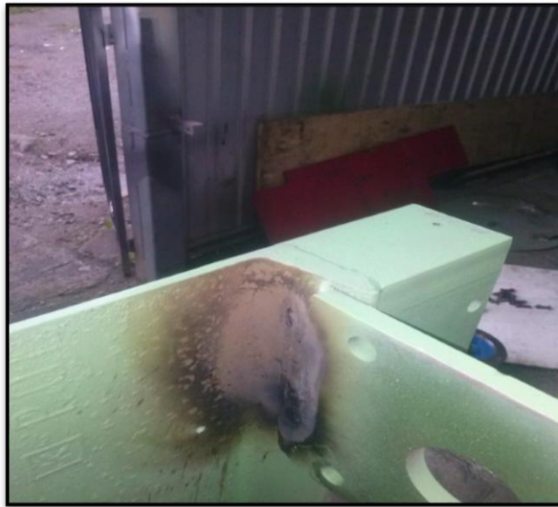
Figura 4.13 Soldadura de los soportes para chumaceras.
