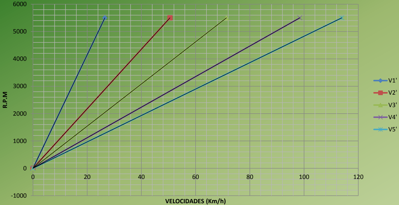
Diagrama de velocidades considerando el par máximo, características técnicas del vehículo Vitara
