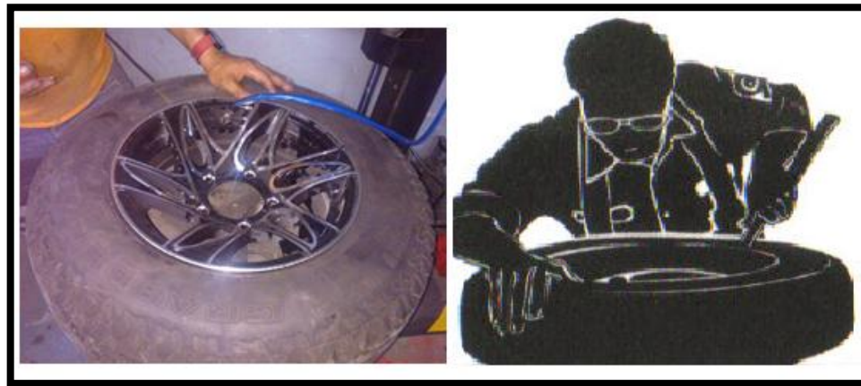
Figura 3. 31 Separación del aro con el neumático.
