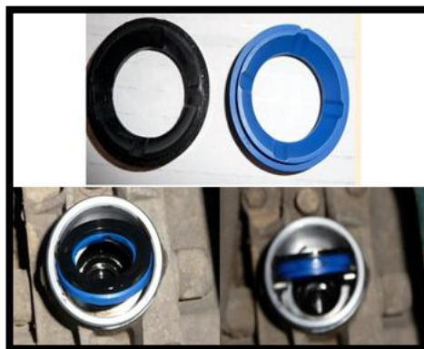
Figura 3. 21 Retenedores palanca de cambios
