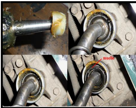
Figura 3. 22 Instalación de apoyos palanca de cambios.
