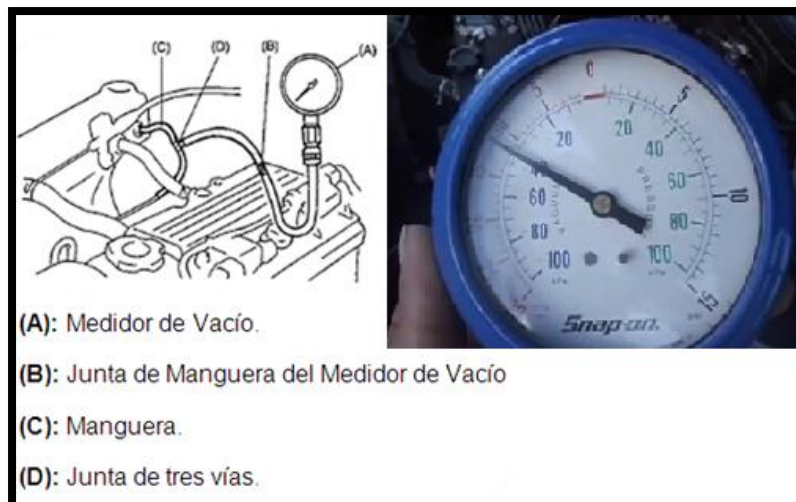
Figura 4. 10 Instalación del vacuómetro.
