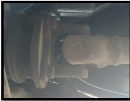
Figura 3. 8 Ensamble árbol de transmisión.
