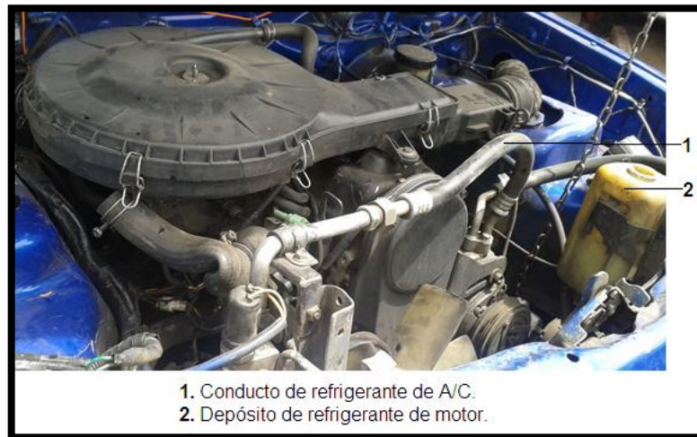
Figura 3. 5 Instalación de mangueras y cañerías de refrigeración.
