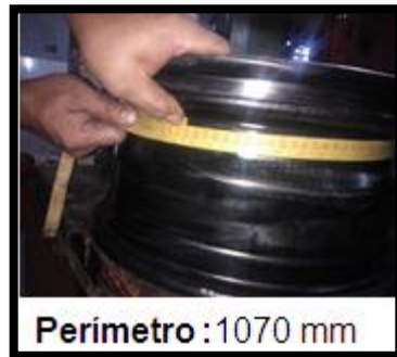
Figura 2. 12 Medición total del aro.
