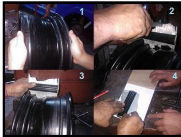
Figura 2. 11 Determinación de perfil del aro.
