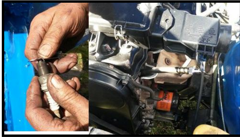
Figura 4. 9 Montaje de bujías.
