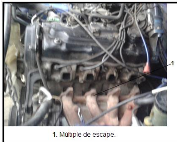
Figura 3. 2 Montaje del múltiple de escape.
