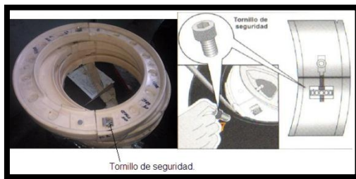
Figura 7. Instalación del Sistema
