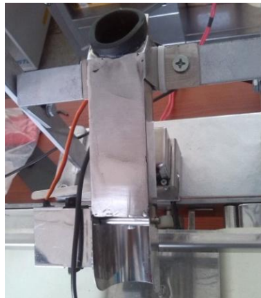
Figura 3.10: Sistema de suministro ensamblado.
