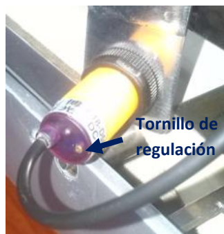
Figura 3.29: Tornillo de regulación del sensor infrarrojo.
