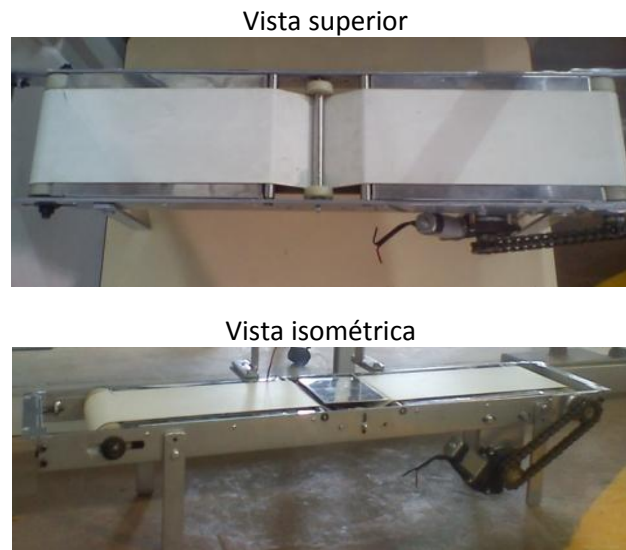
Figura 3.6: Banda transportadora ensamblada.
