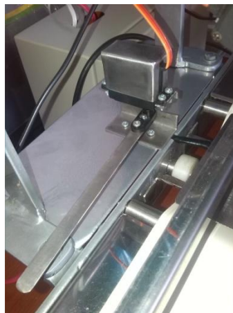
Figura 3.12: Sistema de empuje implementado.
