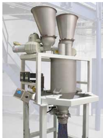
Figura 1.11: Dosificación por ganancia de peso.
