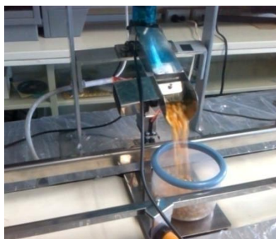
Figura 4.8: Suministro de materia granulada.
