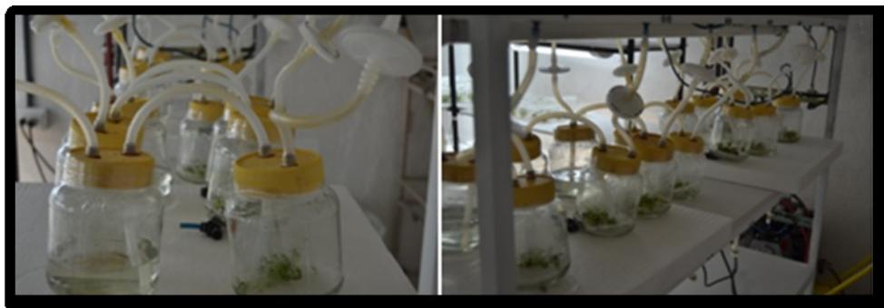
Figura 6 Biorreactores en el Sistema de Inmersión Temporal.
