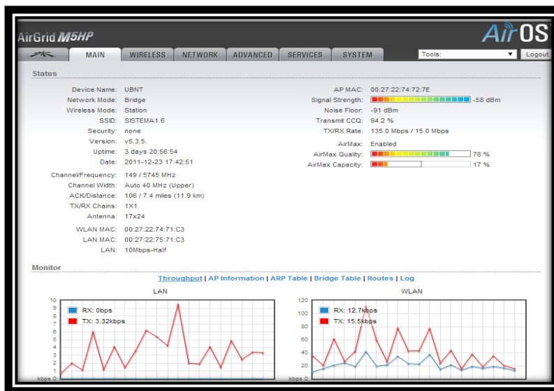
Figura 3.21 Comunicación Wire-Lan Transmisión-Recepción COE- El Calvario (Host)
