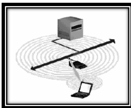
Figura 1.17 Arquitectura basada en Puntos de Acceso
