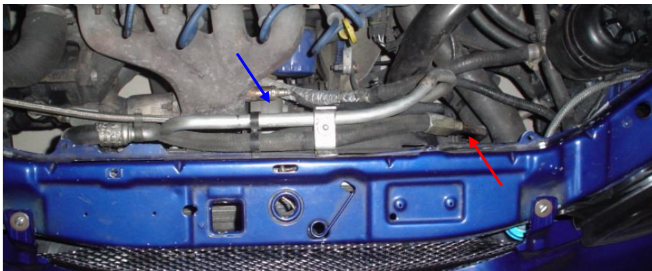
Figura 4.18 Modificación de los conductos de la dirección hidráulica
