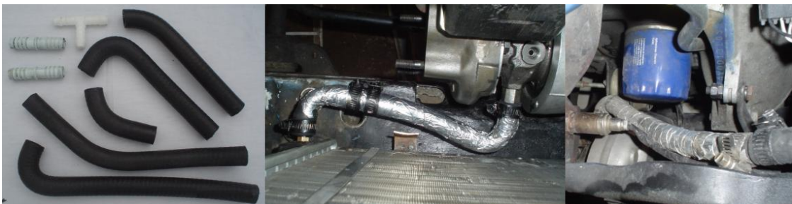
Figura 4.16 Adaptación de las mangueras de refrigeración del turbo
