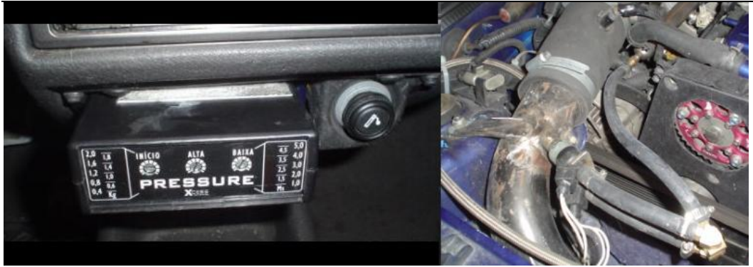
Figura 4.17 Inyectores adicionales y controlador electrónico
