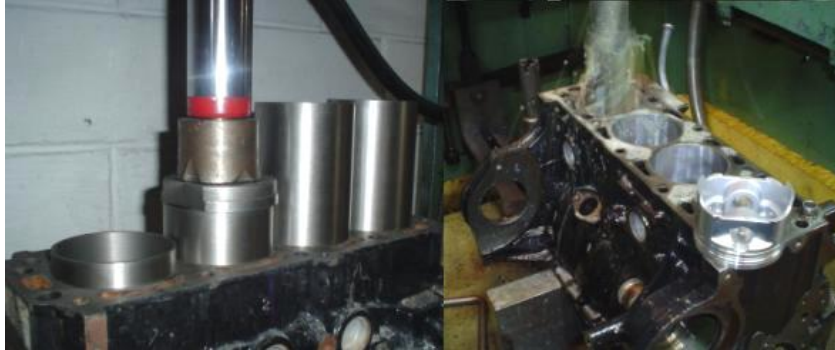
Figura 4.7 Instalación y rectificación de camisas en el bloque del motor
