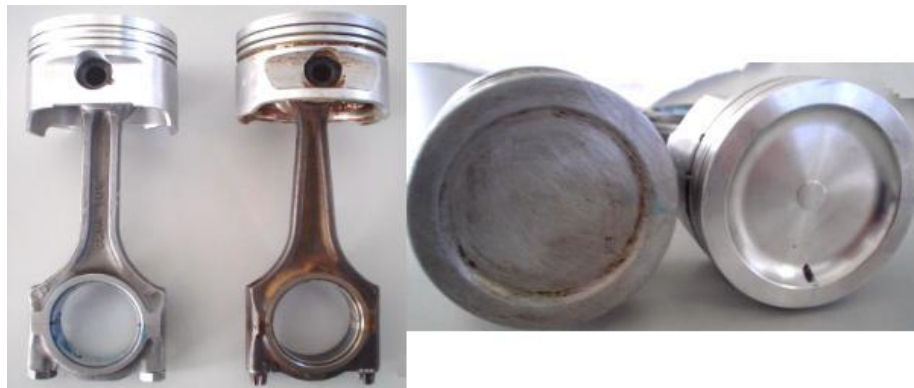
Figura 4.4 Comparación entre el conjunto pistón – biela
