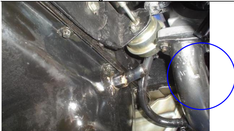
Figura 4.8 Neplo acoplado al cárter para retorno de aceite 4.2 MODIFICACION DE LOS SISTEMAS ANEXOS
