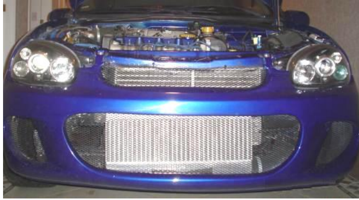
Figura 4.19 Modificación del guardachoque delantero para la instalación del interenfriador
