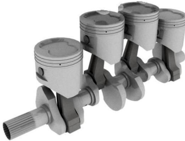
Figura 2.9 Conjunto pistón, biela y cigüeñal
