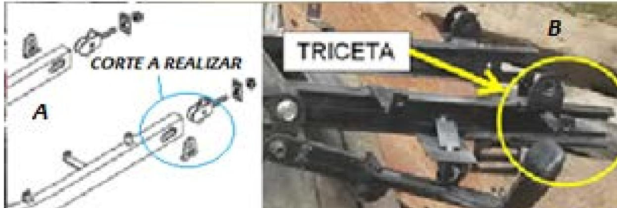
Para la instalación del motor se acondiciona el lugar de su ubicación de manera tal que se fabrica una triceta
