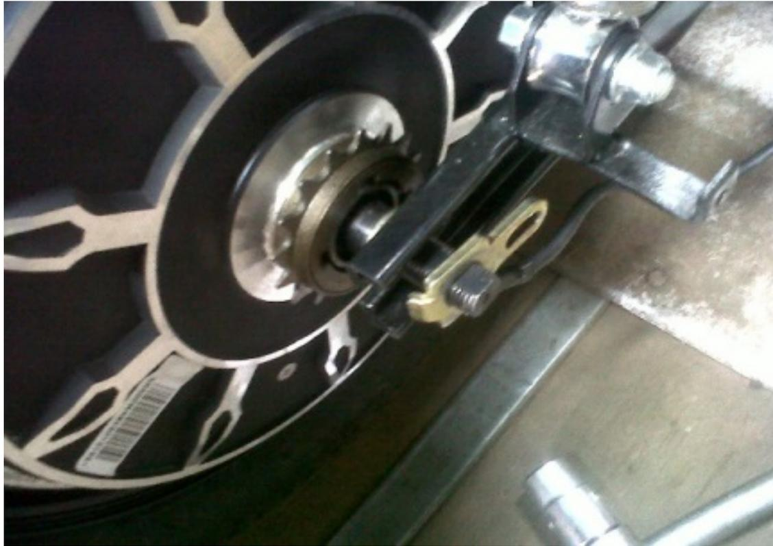
Posteriormente continuamos con la ubicación del motor eléctrico en la triceta que se fabrico.
