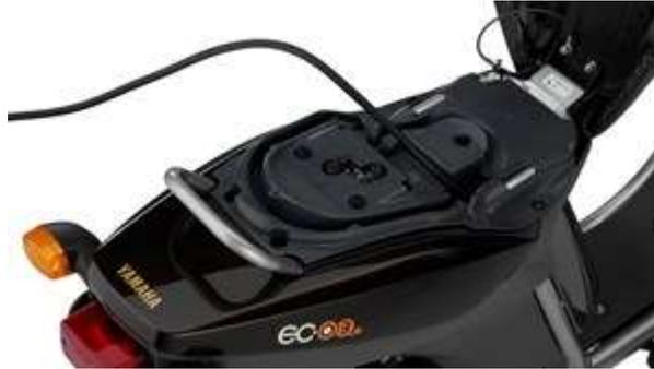
Figura 2.18 Cable del cargador Yamaha EC-03
