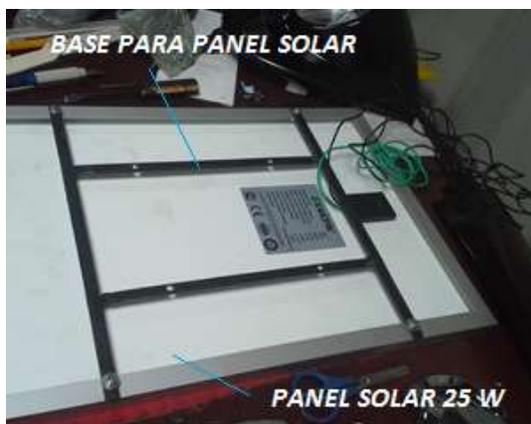
Figura 3.38 Base para el panel solar.
