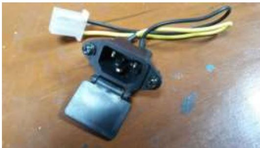
Figura 3.5 Socket del cargador.
