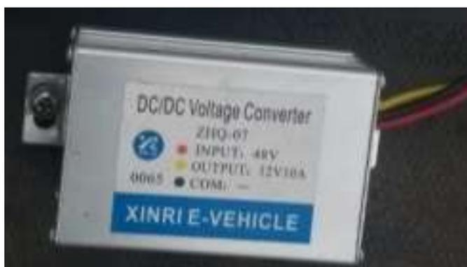
Figura 3.15 Conversor de voltaje.
