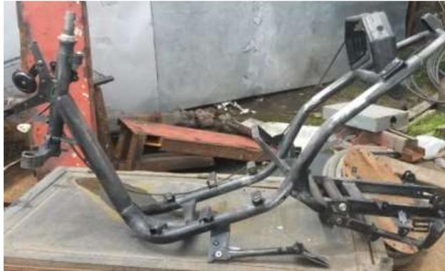
Figura 3.25 Preparación del chasis del scooter.
