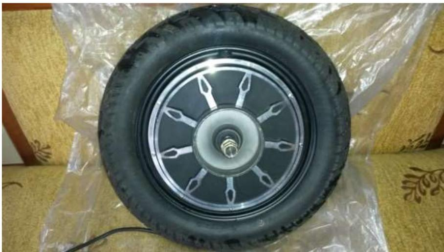
Figura 3.1 Motor eléctrico Brushless de 500W.
