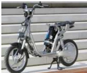
Figura 2.15 Estructura Yamaha EC-03
