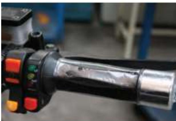
Figura 2.35 Acelerador para motor eléctrico
