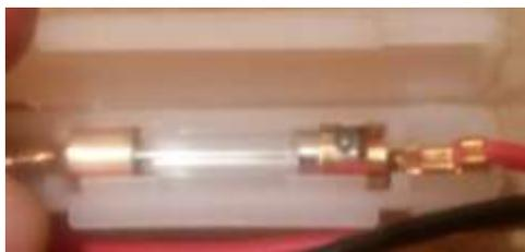
Figura 3.12 Fusible de 4.0 A para el sistema de carga
