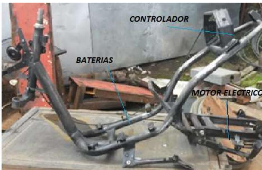
Figura 3.26 Disposición de los elementos
