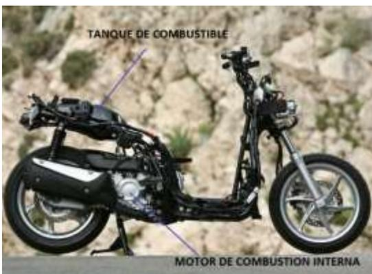
Figura 2.29 Chasis de un scooter
