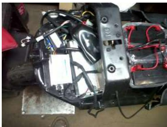
Figura 3.36 Controlador y convertidor instalados
