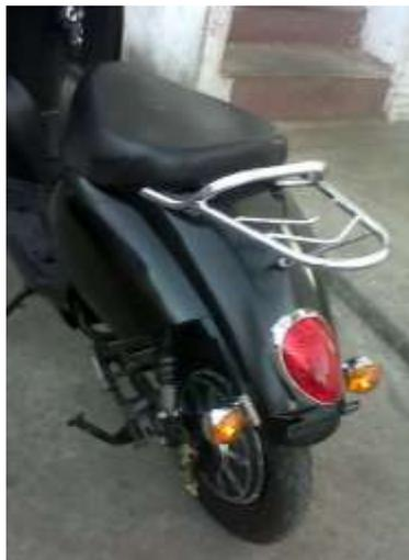
Figura 3.45 Parte posterior del carenado.
