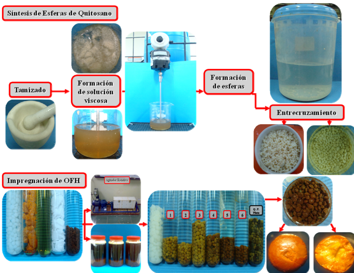
Figura 8.16. Síntesis de esferas de quitosano e impregnación de óxidos de hierro (III).
