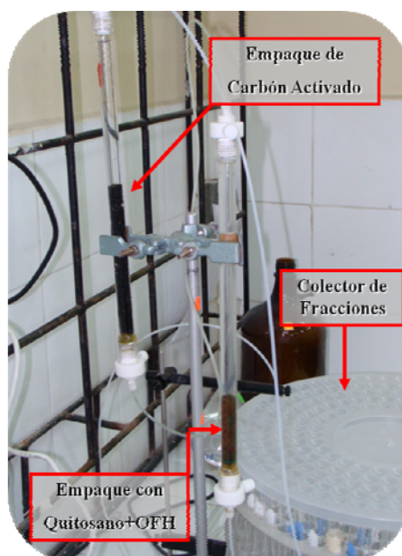
Figura 3.13. Arreglo experimental con doble columna para remover As_T desde las aguas de la vertiente de la laguna de Papallacta.
