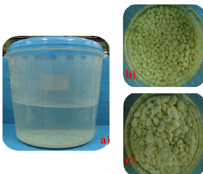
Figura 3.6. a) Esferas sumergidas en glutaraldehído. b) y c) Esferas de quitosano entrecruzadas con glutaraldehído al 2.5%.
