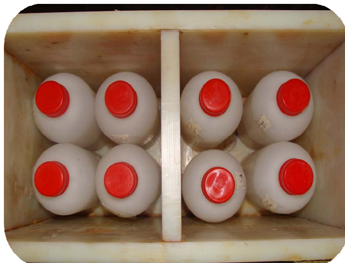
Figura 3.15. Compartimentos en el agitador rotativo, donde son depositados los frascos para ensayos de isotermas.
