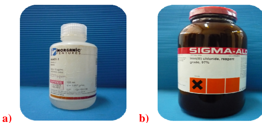
Figura 3.18. a) Estándar de As de la marca utilizado para la curva de calibración en el equipo de adsorción atómica b) Embase de cloruro férrico.
