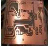
Figura 14: Impresión del circuito en baquelita. Fuente: Cabascango, Dávila, Erazo, Mena
