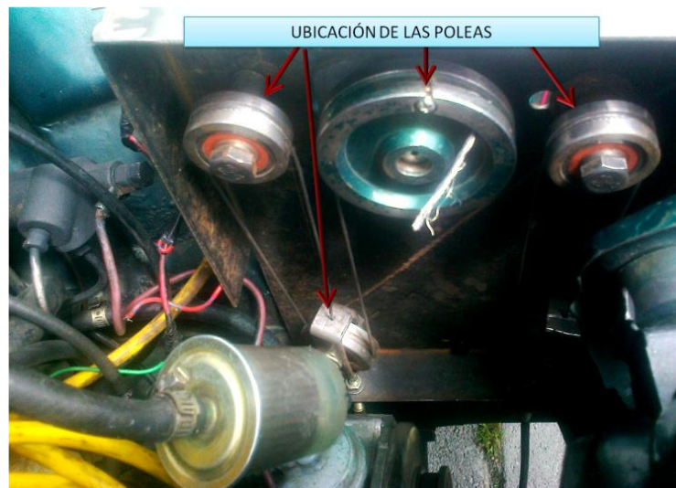
Figura 6.2: Montaje de las poleas en el automóvil Fuente: Baquero, Chimborazo, Quiroz J, Quiroz L.
