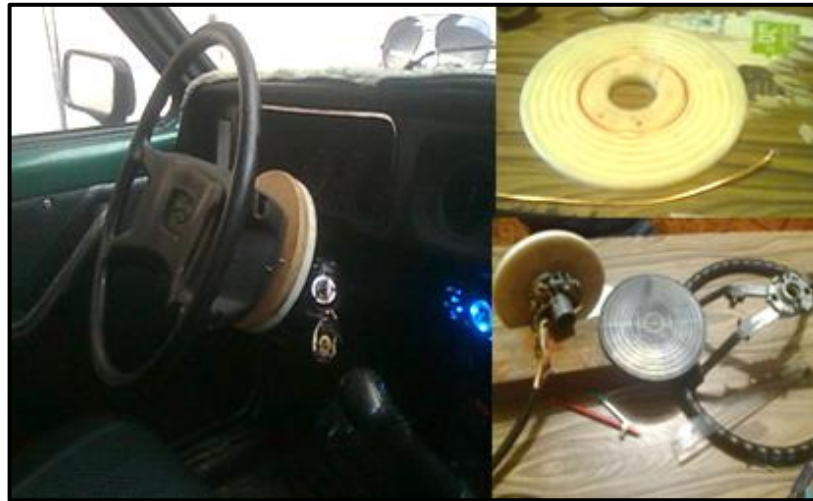
Figura 5.5: Diseño del control en el volante
