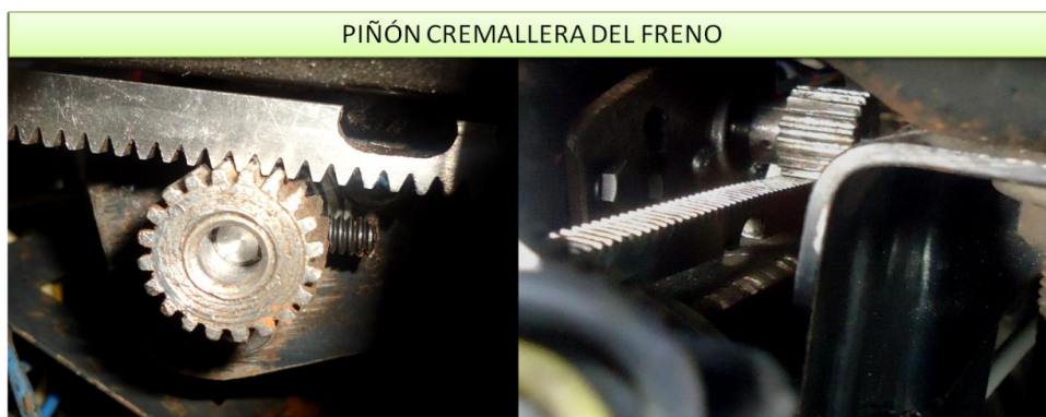
Figura 5.1: Construcción de piñón cremallera
