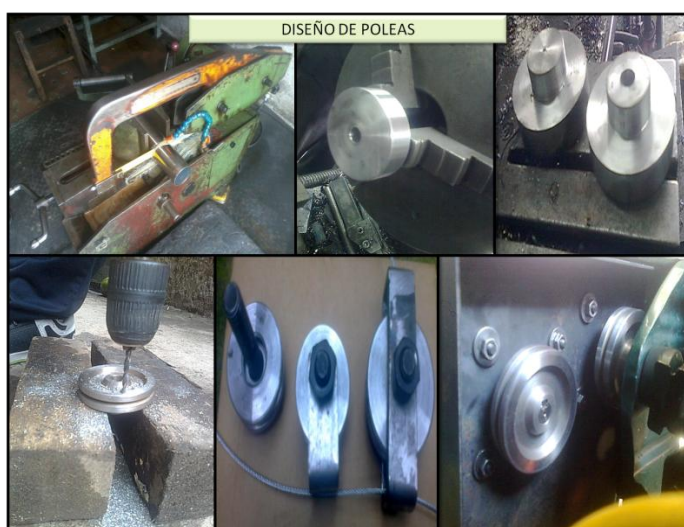
Figura 5.2: Construcción de poleas
