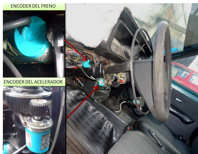
Figura 6.9: Ubicación de los Encoders del freno y acelerador
