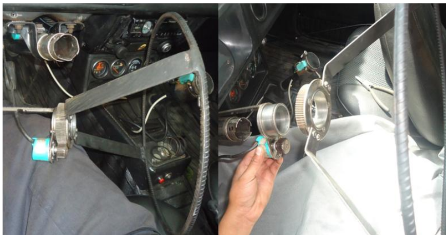
Figura 6.6: Ubicación del accionamiento freno-acelerador
