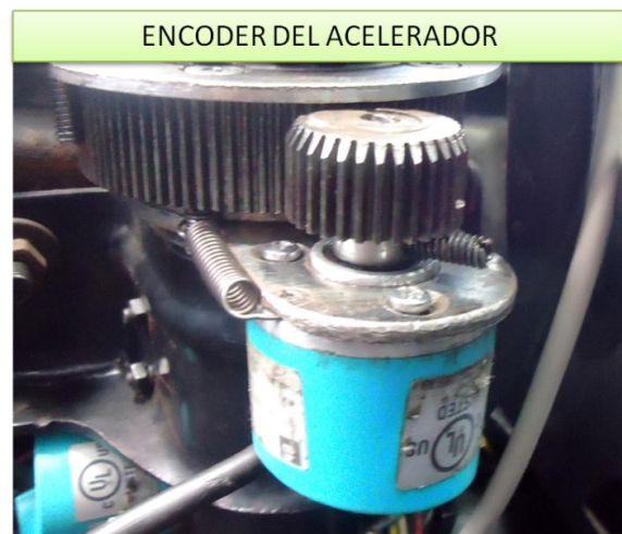
Figura 4.1: Encoder absoluto rotativo con interface SERCOS III
