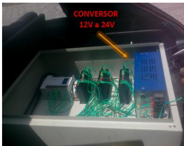
Figura 5.6: Conversor de tensión 12v a 24V Fuente: Baquero, Chimborazo, Quiroz J, Quiroz L.
