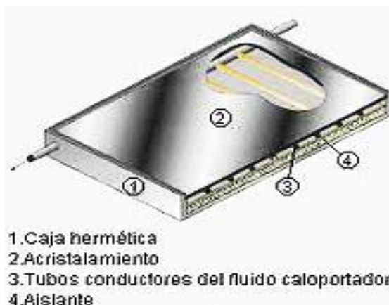
Figura N° 2.12. Esquema de un colector
