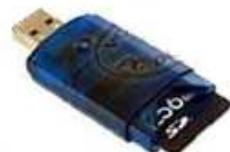
Fig. 14. Adaptador MMC/SD a USB
