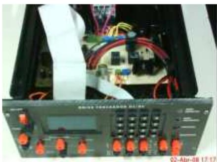
Fig.19. Drive troceador DC/DC vista frontal.
