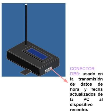
Fig. 11. Componentes del Receptor (Vista Posterior)
