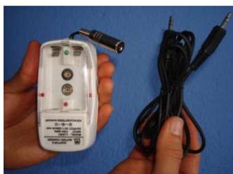
Fig. 19. Cargador y Cable para Batería 9V
