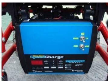
Fig. 20. Controlador principal y cargador
