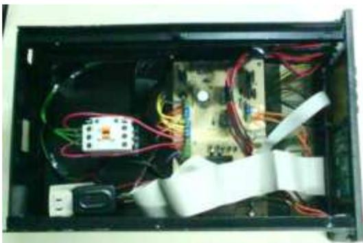
Fig. 18. Drive troceador DC/DC vista superior.
