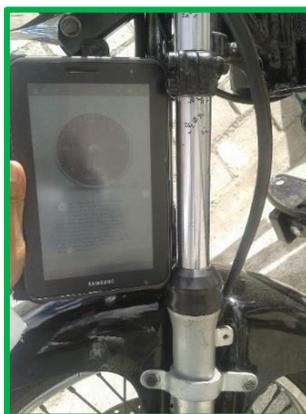
**Figura 5-7 Ángulo de lanzamiento**
