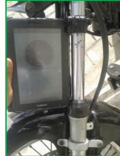
**Figura 25 Ángulo de lanzamiento**
