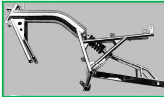
**Figura 2-29 Sistema mono-shock con amortiguador inclinado**
