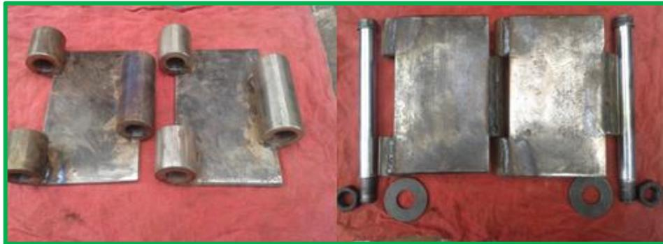
**Figura 4-17 Construcción de la bisagra**
