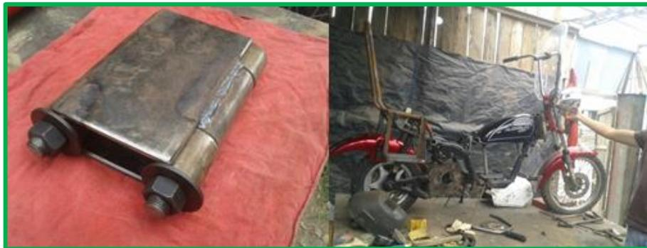
**Figura 4-18 Ubicación de la bisagra en el bastidor**
