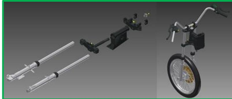
**Figura 4-1 Ensamblaje sistema de dirección**
