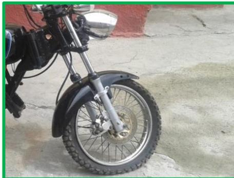
**Figura 4-14 Sistema de freno de disco sobre la rueda delantera**
