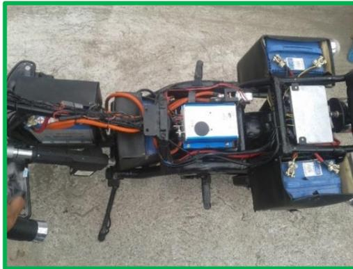
**Figura 5-1 Ubicación de los elementos del sistema eléctrico motriz**
