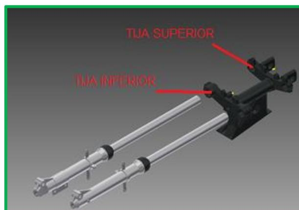
**Figura 3-5 Modelación del sistema de dirección**
