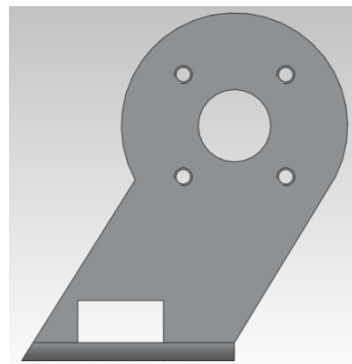
Figura 3.14. Propuesta a realizarse en la articulación para pinza del servo motor DYNAMIXEL MX28T.
