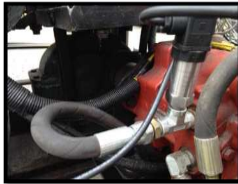
Figura 4.6 Implementación del sensores de presión aceite hidráulico.
