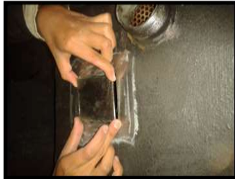
Figura 4.2. Implementación de la base del sensor de nivel aceite hidráulico.
