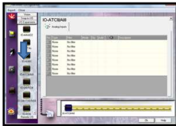
Figura 4.37 Selección del módulo de expansión I/O ATC8/A18
