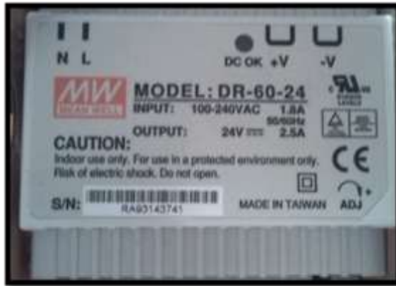
Figura 3.12 Fuente de voltaje 110/ 24v
