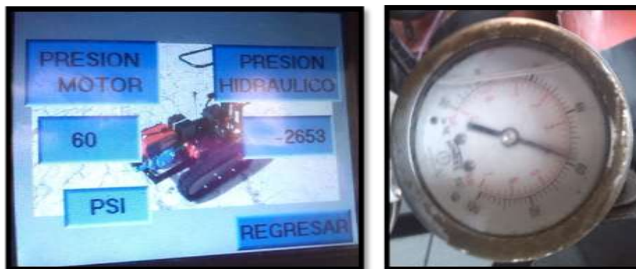
Figura 5.8: Monitoreo de presión tractor encendido
