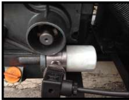
Figura 4.5 Acople de un eje como base para el sensor de presión motor.
