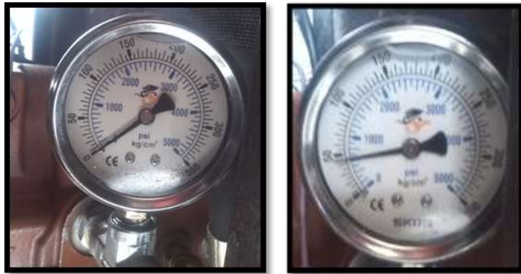
Figura 5.9: Monitoreo de presión sistema hidráulico tractor
