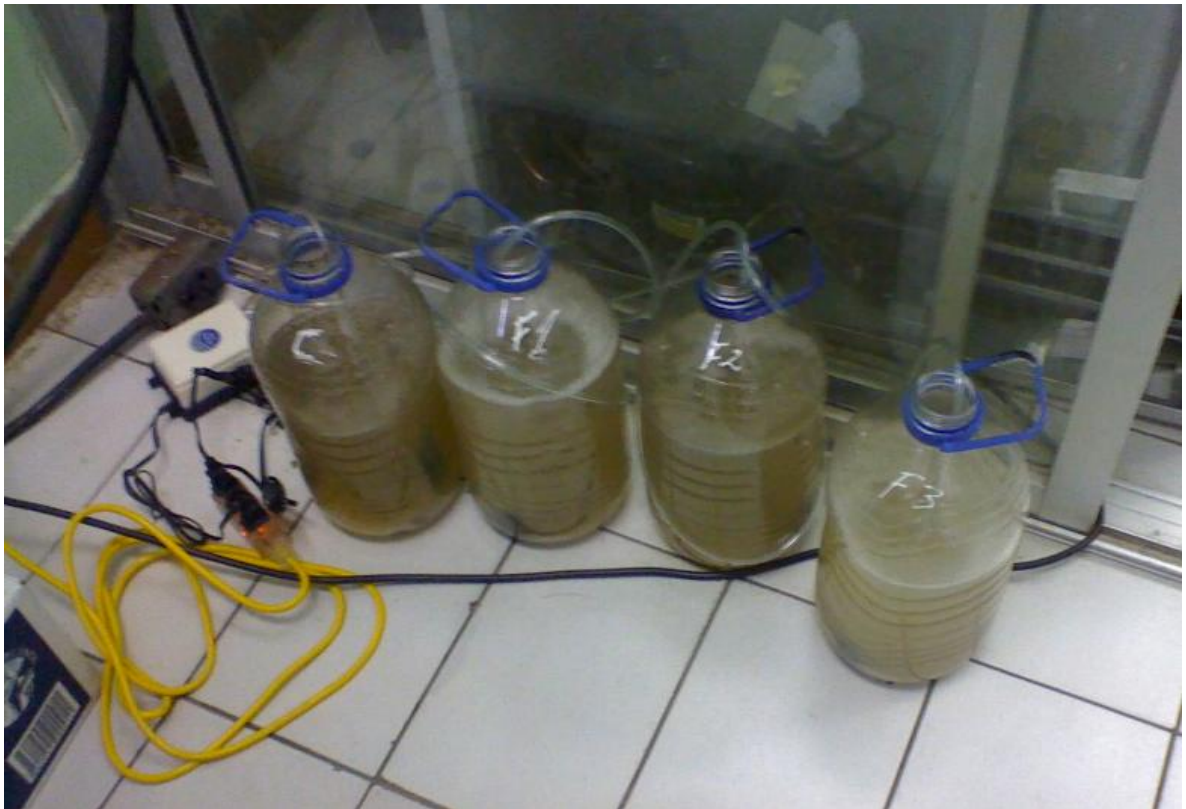
Figura 2.15 Reactores aireados con agua de la piscina de lodos activados y fórmulas. C= control, F1=fórmula 1, F2= fórmula 2, F3= fórmula 3.
