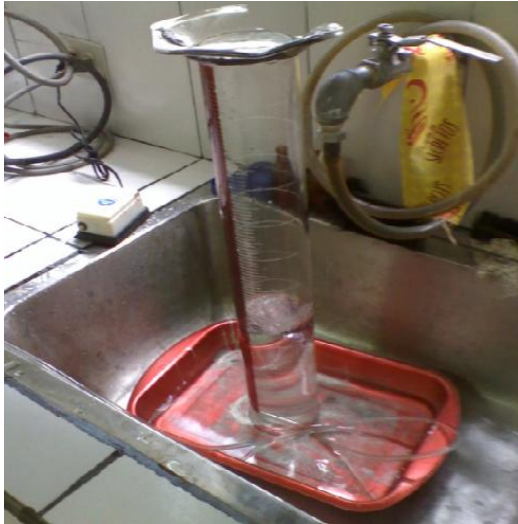
Figura 2.14 Medición de caudal de oxígeno de los motores de pecera
