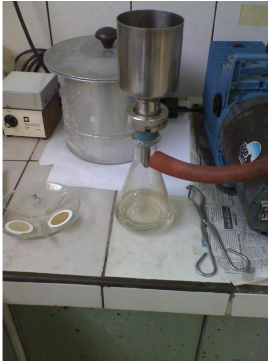
Figura 2.5 Equipo de filtración para prueba de sólidos suspendidos
