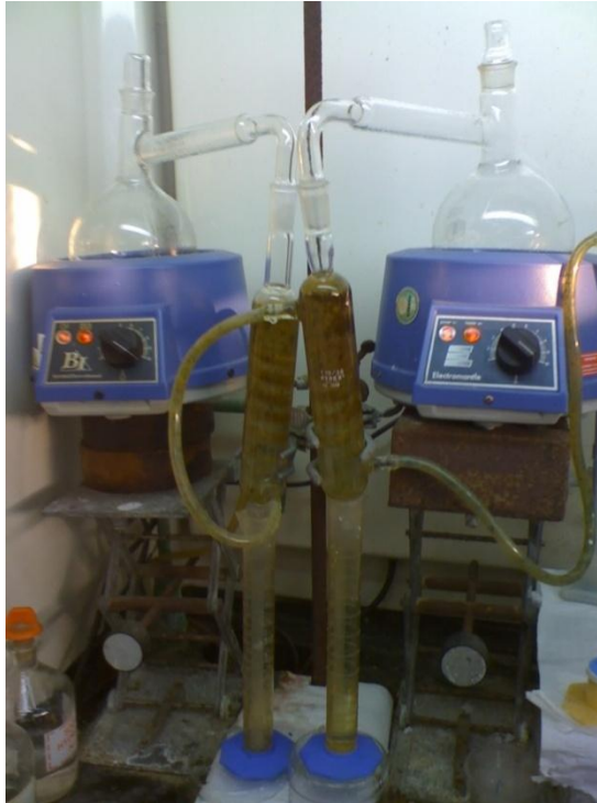
Figura 2.8 Prueba de fenoles, equipo de destilación para la extracción de fenoles por arrastre
