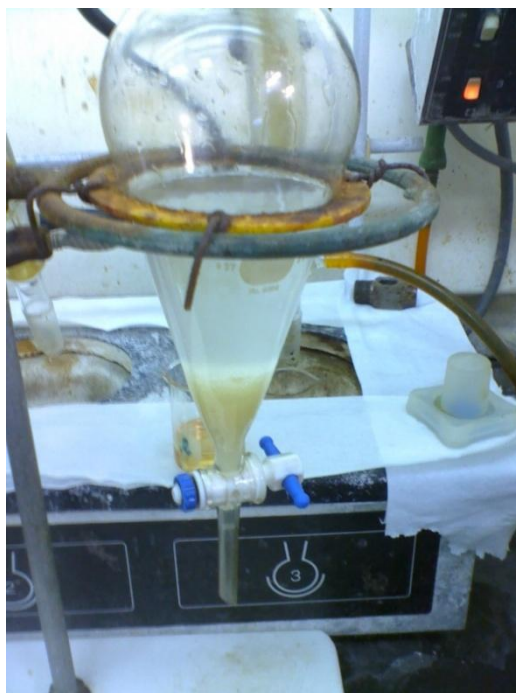
Figura 2.7 Prueba de TPH's formación de las dos fases, polar y apolar, en la mezcla.
