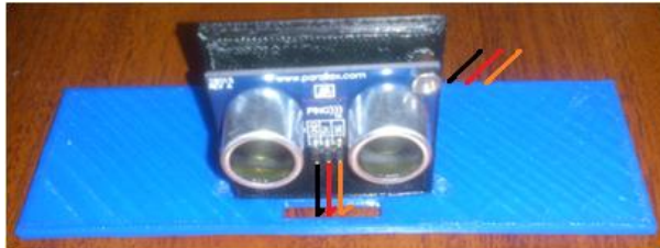
Figura 3.83. Colocación de los cables del sensor.
