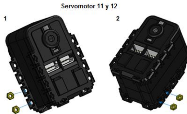
Figura 3.8. Disposición de tuercas en los servomotores ID11 e ID12.
