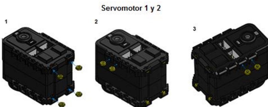
Figura 3.3. Disposición de tuercas en los servomotores ID1 e ID2.
