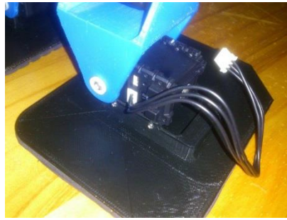
Figura 3.58. Conexión del cable del servomotor 9.
