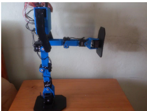
Figura 4.1. Posición donde se requiere mayor torque.
