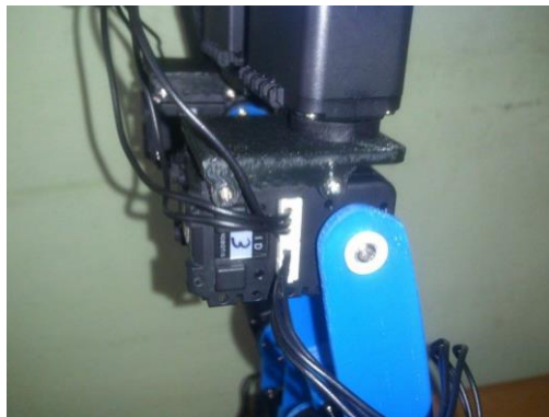
Figura 3.61. Conexión del cable entre los servomotores 5 y 3.
