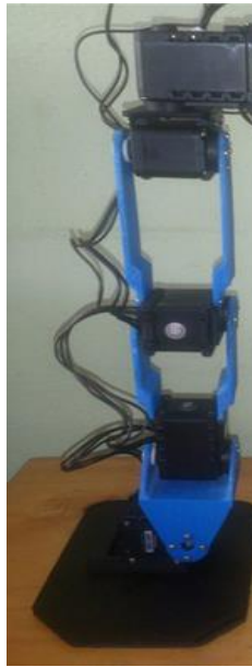
Figura 3.62. Conexión de los servomotores de la pierna derecha.
