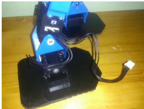
Figura 3.59. Conexión del cable entre los servomotores 9 y 7.
