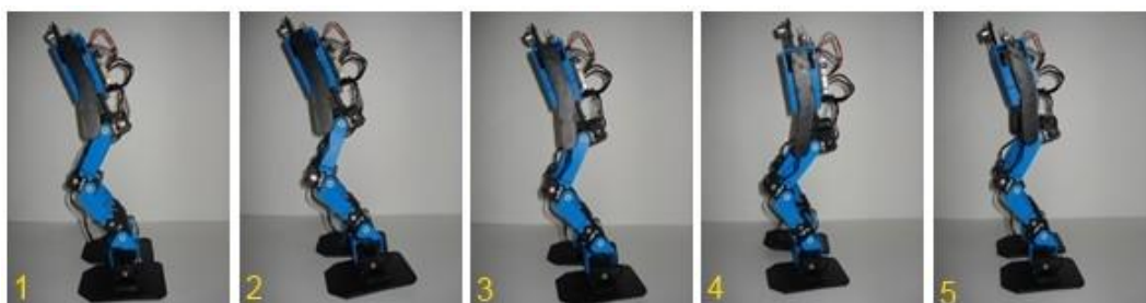
Figura 3.128. Giro a la izquierda del robot bípedo en el plano sagital.
