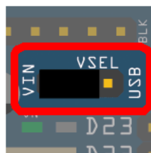
Figura 3.99. Jumper energía Arbotix-M con servomotor.
