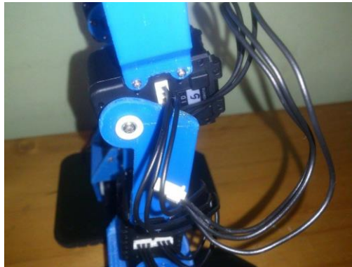
Figura 3.60. Conexión del cable entre los servomotores 7 y 5.
