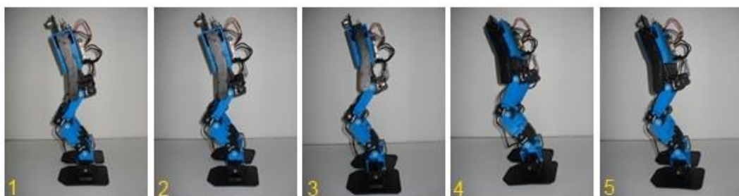
Figura 3.126. Giro a la derecha del robot bípedo en el plano sagital.
