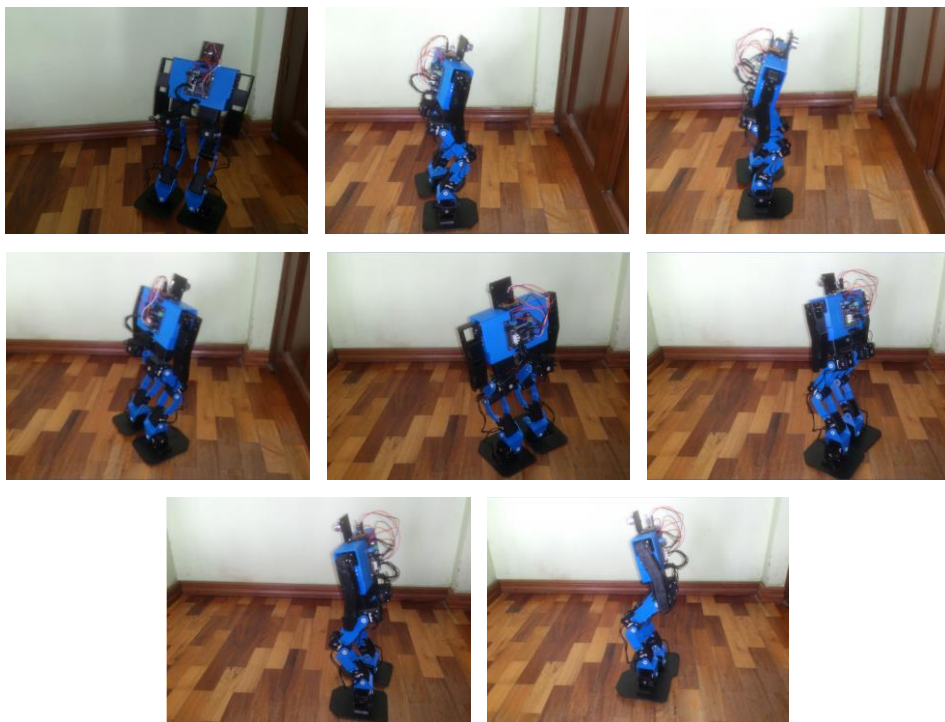
Figura 4.27. Prueba dos de la caminata del robot bípedo.
