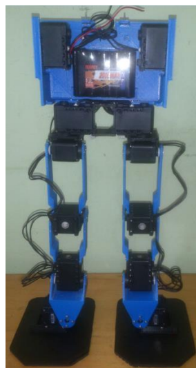
Figura 3.74. Cableado de los servomotores 11 y 12.
