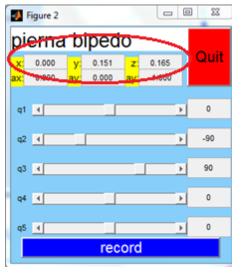
Figura 2.33. Valores articulares del ejemplo de cinemática directa del robot bípedo.
