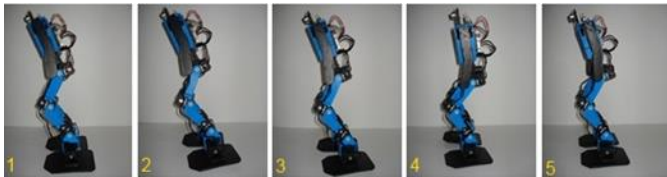
Fig. 18. Trayectorias del giro a la izquierda del robot bípedo en el plano sagital.
