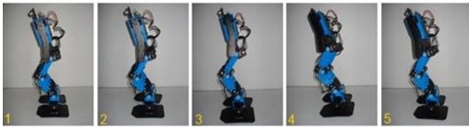
Fig. 16. Trayectorias del giro a la derecha del robot bípedo en el plano sagital.
