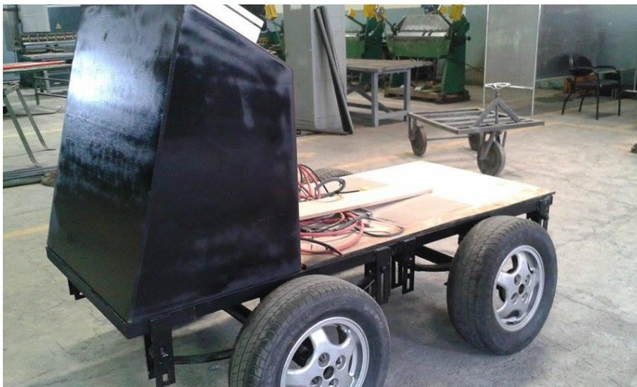
Figura 4.16: Piso de madera fijado a la estructura del banco
