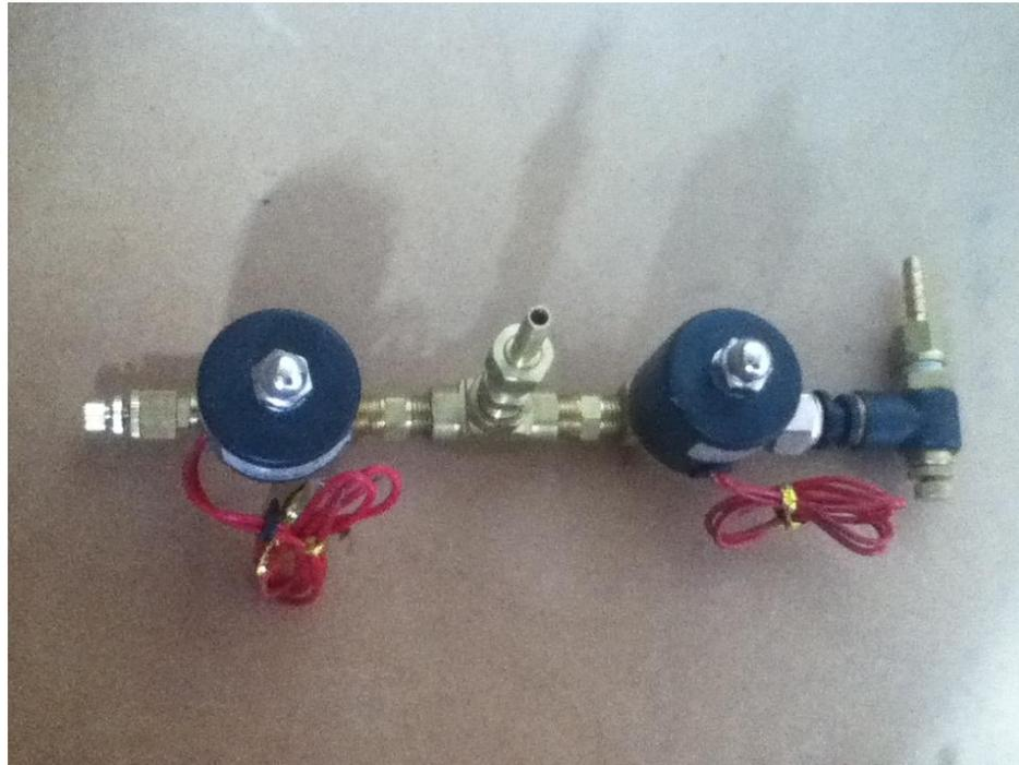
Figura 3.3: Electroválvula 4/2 (Cuatro Vías y Dos Posiciones)
