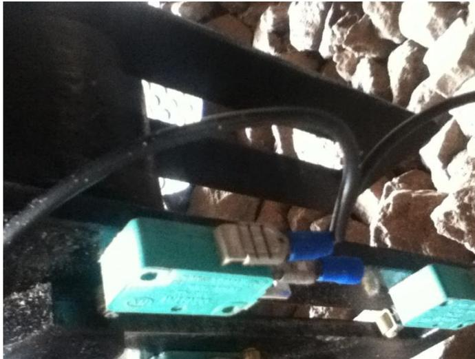
Figura 4.28: Conexiones a los finales de carrera
