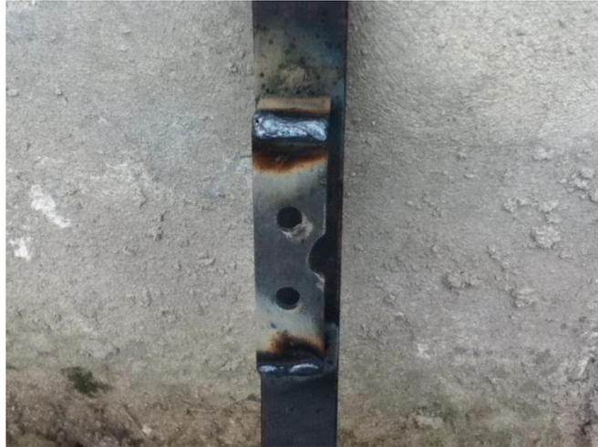
Figura 4.7: Base metálica en la cara superior de la hoja de ballesta
