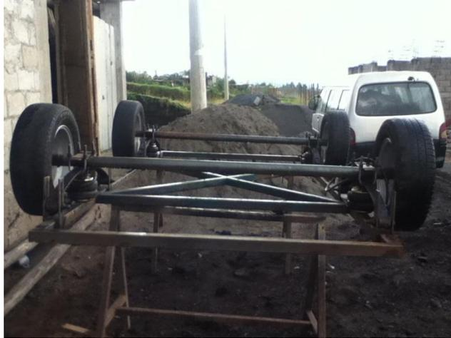
Figura 4.11: Disposición de los ejes motrices
