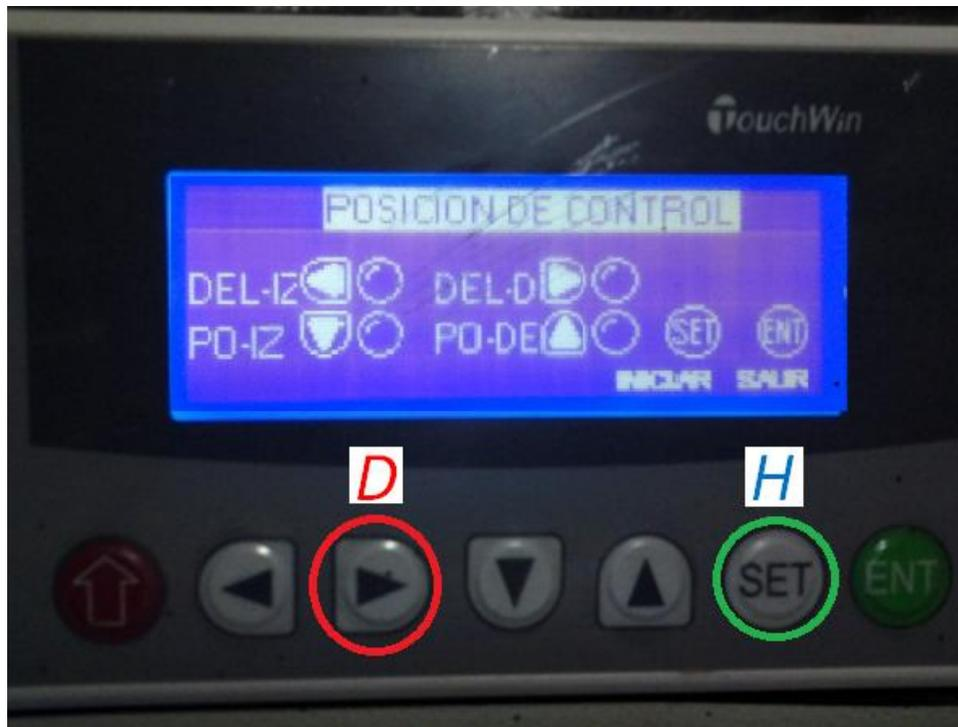
Figura 5.7: Control neumático delantero derecho
