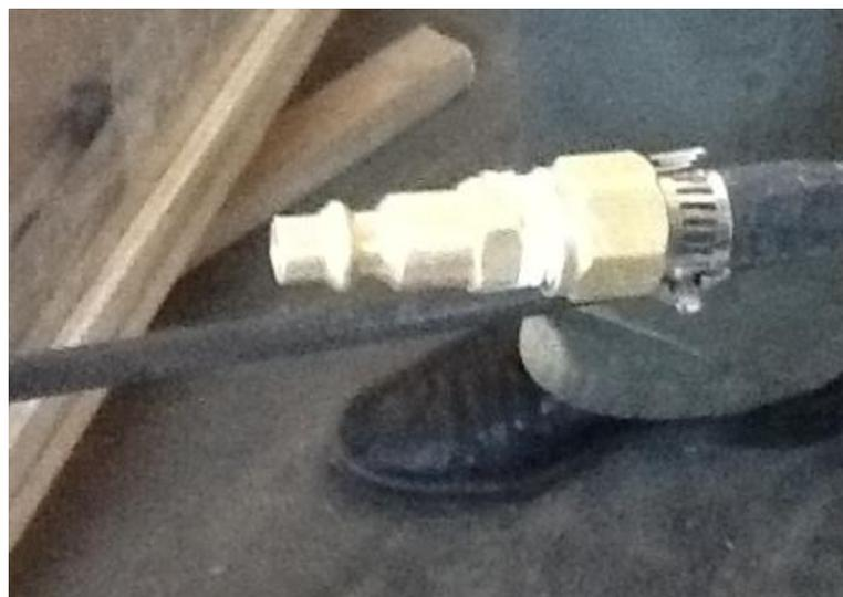
Figura 3.21: Acople neumático
