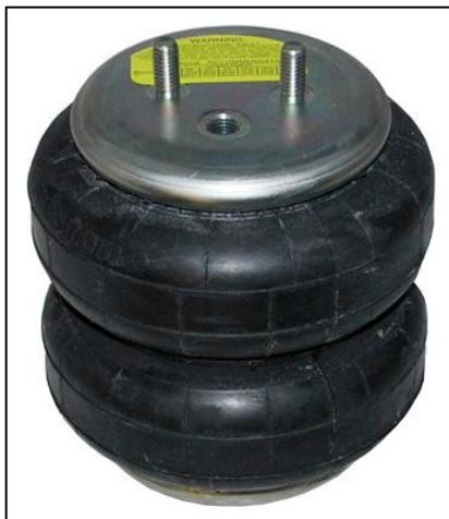
Figura 2.21: Fuelle neumático
