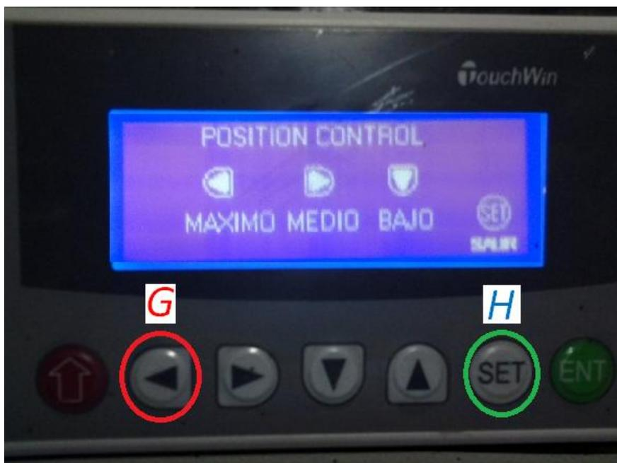
Figura 5.10: Control del nivel de altura para dos actuadores
