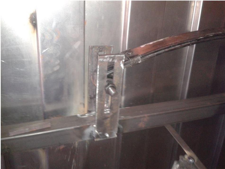
Figura 4.4: Colocación de las hojas de ballesta, pernos y placas guías
