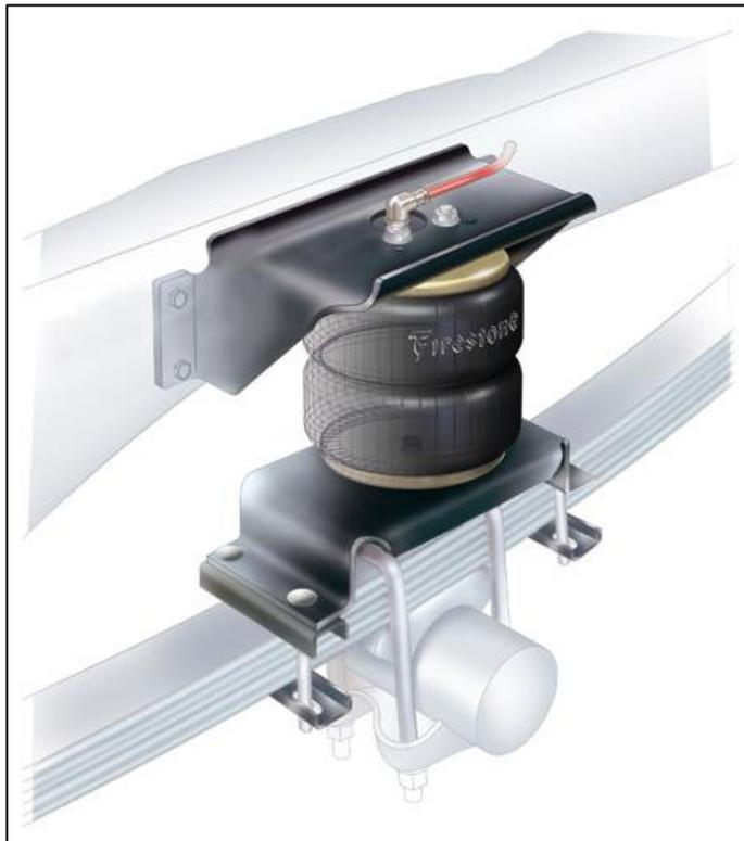
Figura 2.20: Sistema de suspensión con fuelle neumático
