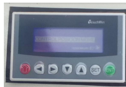
Figura 3. Terminal programable marca Touchwin
