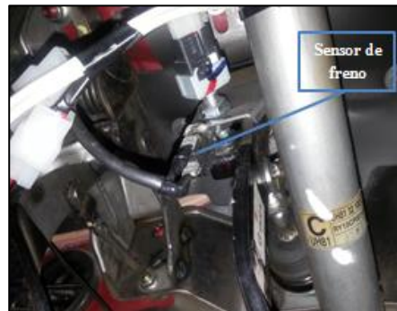
Figura 14. Sensor de freno.
