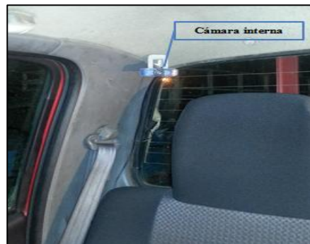
Figura 19. Ubicación cámara interna.
