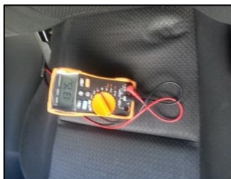
Figura 21. Prueba del sensor del freno (Pedal presionado).
