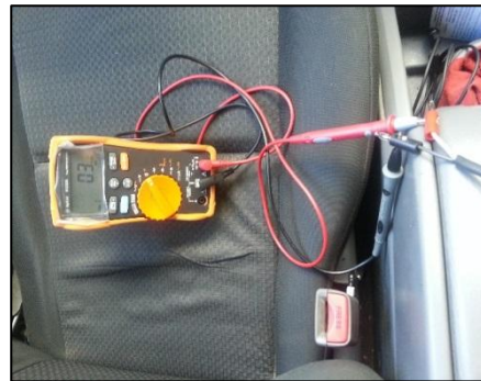
Figura 22. Prueba del sensor del cinturón (desabrochado).
