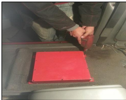
Figura 16. Perforación y sujeción de la caja electrónica registradora de datos.
