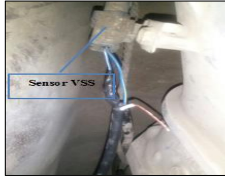
Figura 13. Sensor de velocidad VSS.
