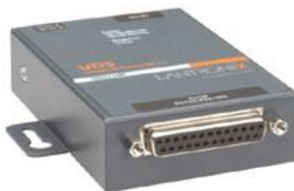
Figura N° 3.5 Conversor RS-232 Ethernet UDS 1100
