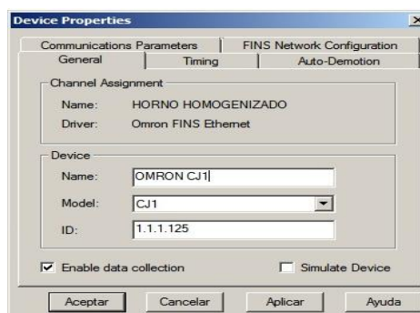
Figura Nº 3.24 Parámetros PLC OMRON
