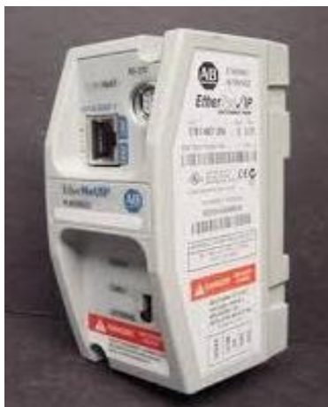
Figura N° 3.3 Módulo de comunicación 1746-NET-ENI
