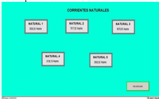
Figura N°9 Corriente de los rectificadores de los naturales de anodizado
