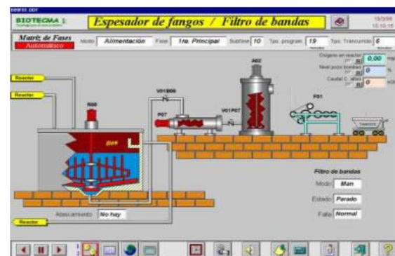
Figura N° 1 Ejemplo de aplicación de un Sistema SCADA
