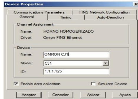
Figura N° 6 Parámetros comunicación PLC fundición
