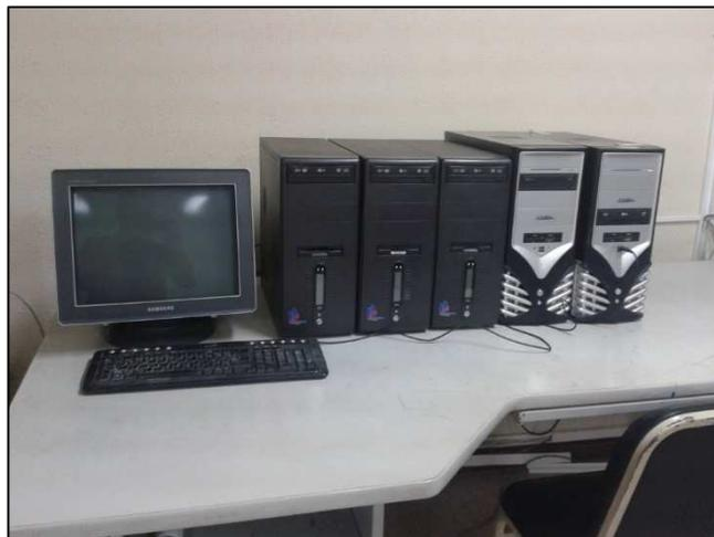
**Figura 4.87 Clúster implementado, nodos esclavos del 5-9**
