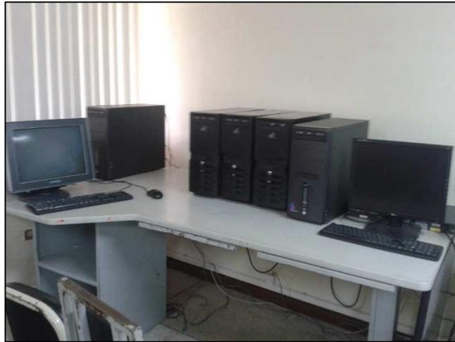
**Figura 4.86 Clúster implementado, nodo Maestro y nodos esclavos**
