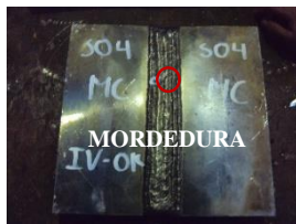
Figura 3. INSPECCIÓN VISUAL DE LOS CUPONES DE SOLDADURA a) PROCEDIMIENTO S01 CON MORDEDURA EN LA ZONA SUPERIOR, b) PROCEDIMIENTO S02, c) PROCEDIMIENTO S04 CON MORDEDURA EN LA ZONA MEDIA SUPERIOR.
