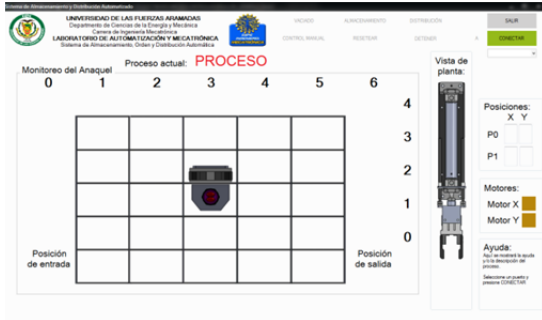
Figura 8. Ventana principal de la HMI.
