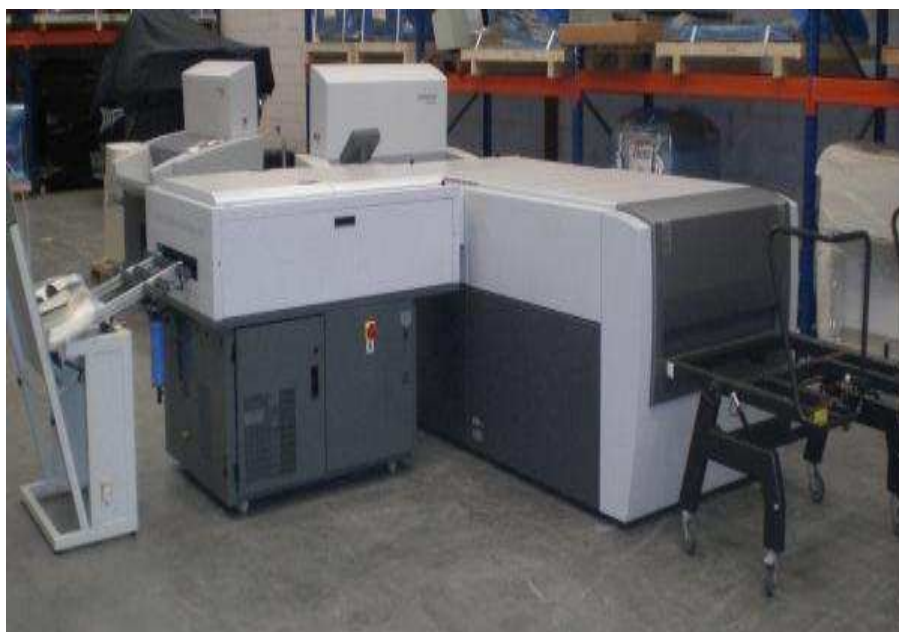
Fotografía 3 Imprenta Offset Ctp Heidelberg Prosetter 74
