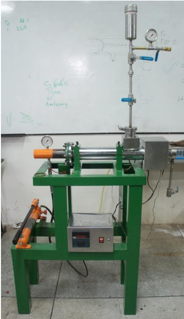
IMAGEN 1: Micro Extrusora Experimental de Biomasa
