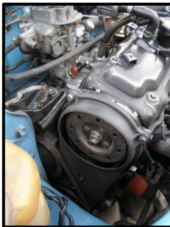
Figura 2.39: Distribución Por Correa Dentada.
