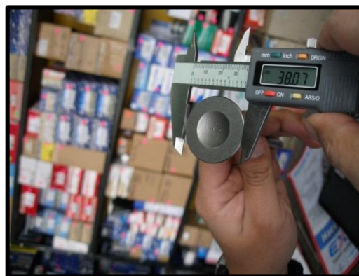
Figura 3.14: Diámetro Válvula de Admisión Vitara JX.
