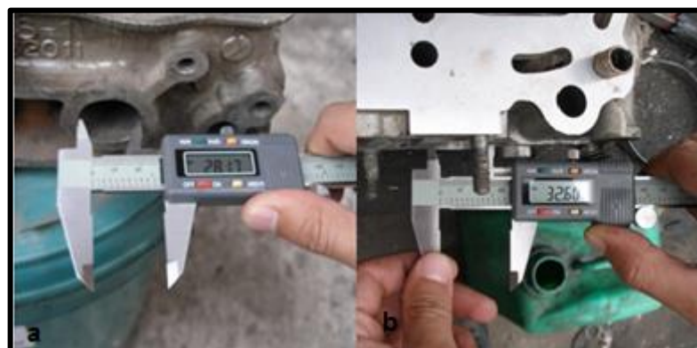
Figura 2.11 a): Conducto de Admisión Original 2.11 b): Conducto de Admisión Modificado.
