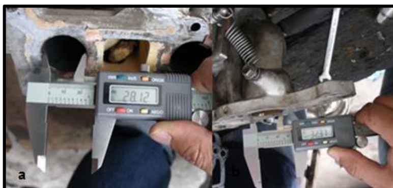
Figura 2.14 a): Múltiple de Admisión Original 2.14 b): Múltiple de Admisión Preparado.
