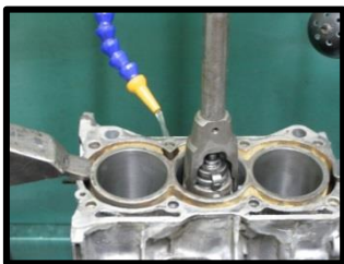
Figura 2. Bruñido de cilindro.
