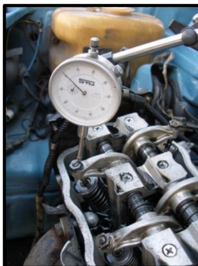
Figura 2.30: Reloj Palpador Balancín Válvula de Escape.
