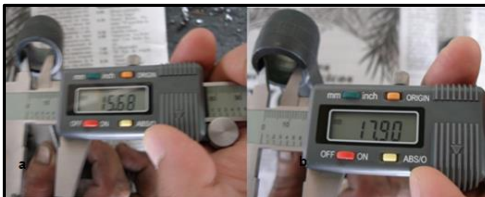
Figura 2.19 a): Diámetro de Bulón Biela Original 2.19 b): Diámetro de Bulón Biela Modificado.
