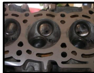
Figura 4. Conductos de Admisión Modificados
