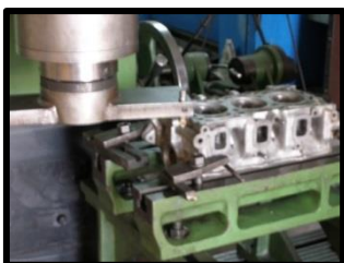
Figura 3. Cepillado de la Culata.
