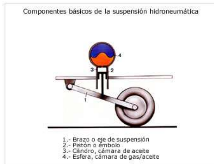
Figura. 2.33 Suspensión Hidroneumática
