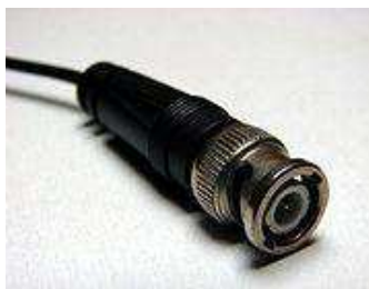
Figura 2.20 Conector BNC para SDI
