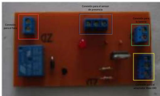
Figura 8. Placa del control de iluminación
