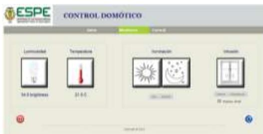
**Figura 14. Visualización de valores de temperatura y luminosidad**
