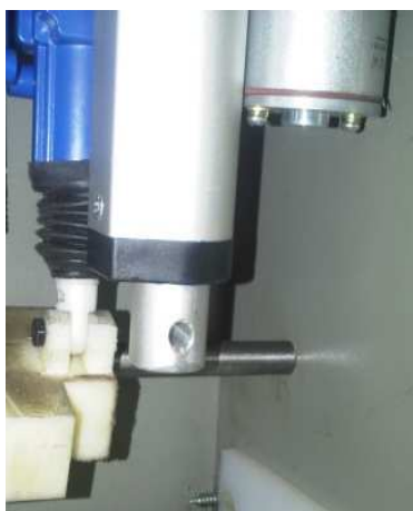
Figura. 111 Actuador lineal del salto de línea desactivado
