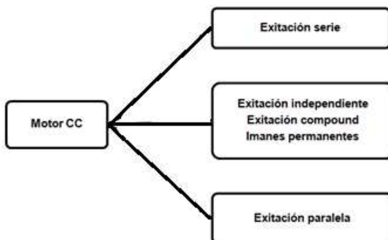
Figura 26 Clasificación de los Motores DC
