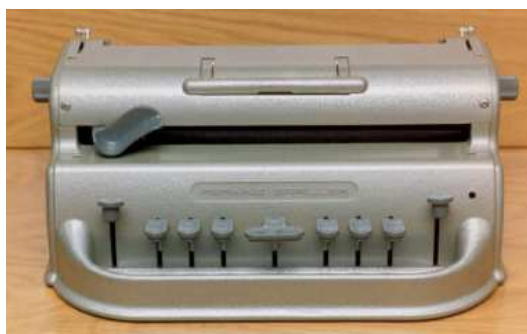
Figura 2 Máquina de Escribir Braille – Perkins (BAC)
