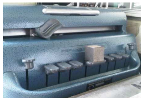
Figura 53 Tecla presionada por 0.77 [kg]
