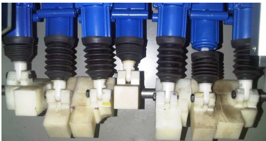
Figura 108 Letra “q” interpretada por los actuadores lineales
