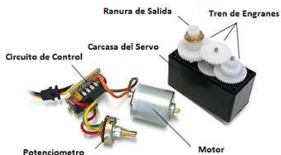
Figura 32 Estructura interna de un servomotor.
