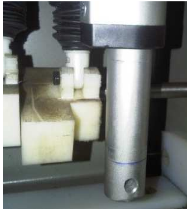
Figura. 112 Actuador lineal del salto de línea activado
