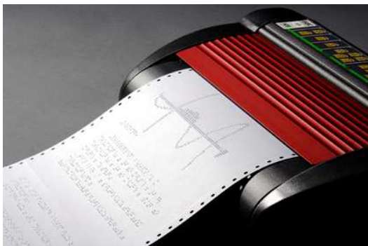
Figura 25 Impresora Braille. (BAC)
