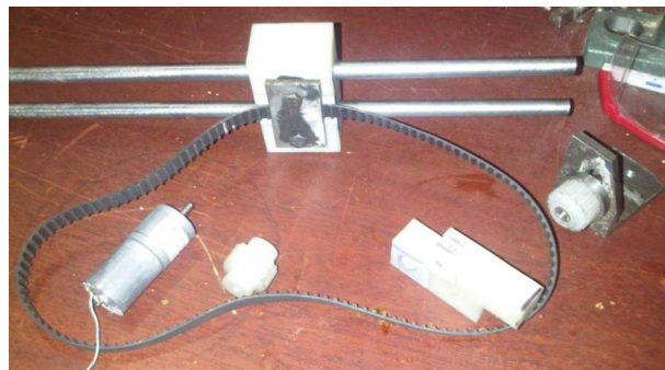
Figura 67 Motor reductor, poleas dentadas, banda
