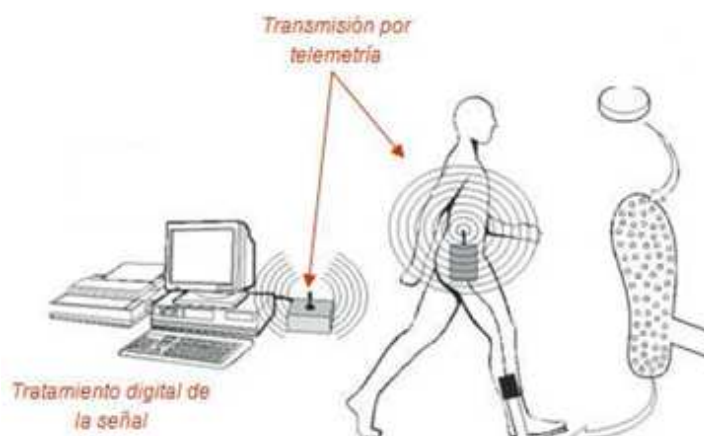
Figura 51. Elementos que componen un Sistema de Baropodometría Fuente: (Encarnación, 2012).
