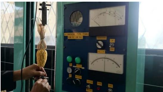
Figura 9. Simulación del proceso de deshojado (máquina de tracción).
