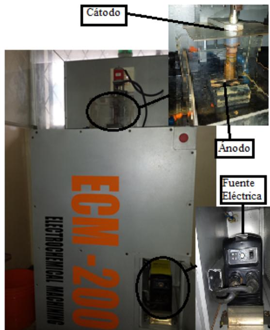
**Figura 73.** Sistema De Fuente Eléctrica
