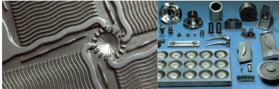
**Figura 23.** Modelos de Maquinados por ECM
