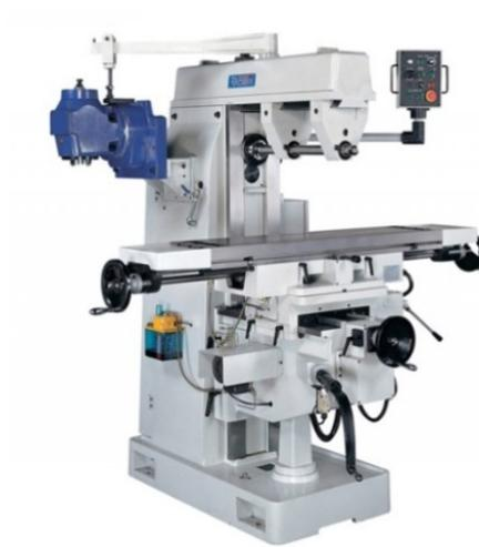
**Figura 6.** Fresadora Universal Fama Hu 300
