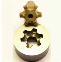
**Figura 24.** Fabricación de moldes por ECM
