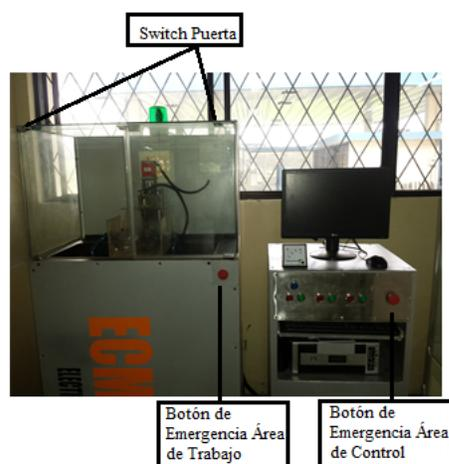
**Figura 77.** Sistemas De Seguridad
