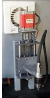
**Figura 76.** Sistema De Avance De La Herramienta
