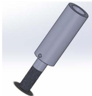
**Figura 49.** Eje para Conexión Eléctrica
