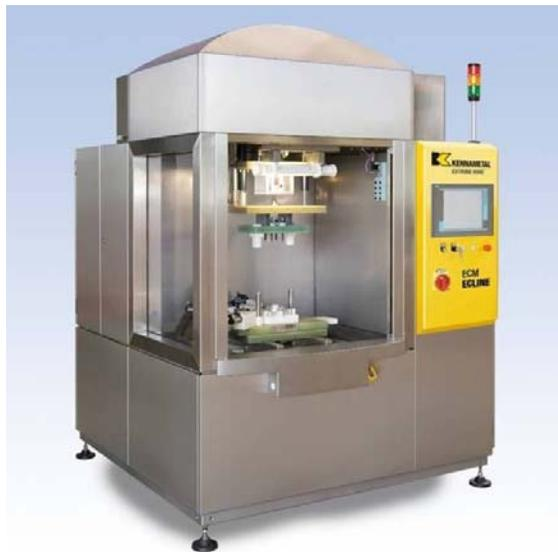
**Figura 2.** Máquina para Mecanizado Electroquímico
