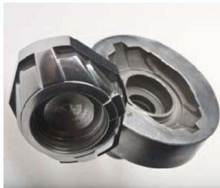
**Figura 1.** Pieza maquinada con proceso electroquímico
