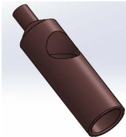
**Figura 29.** Electrodo de Cobre
